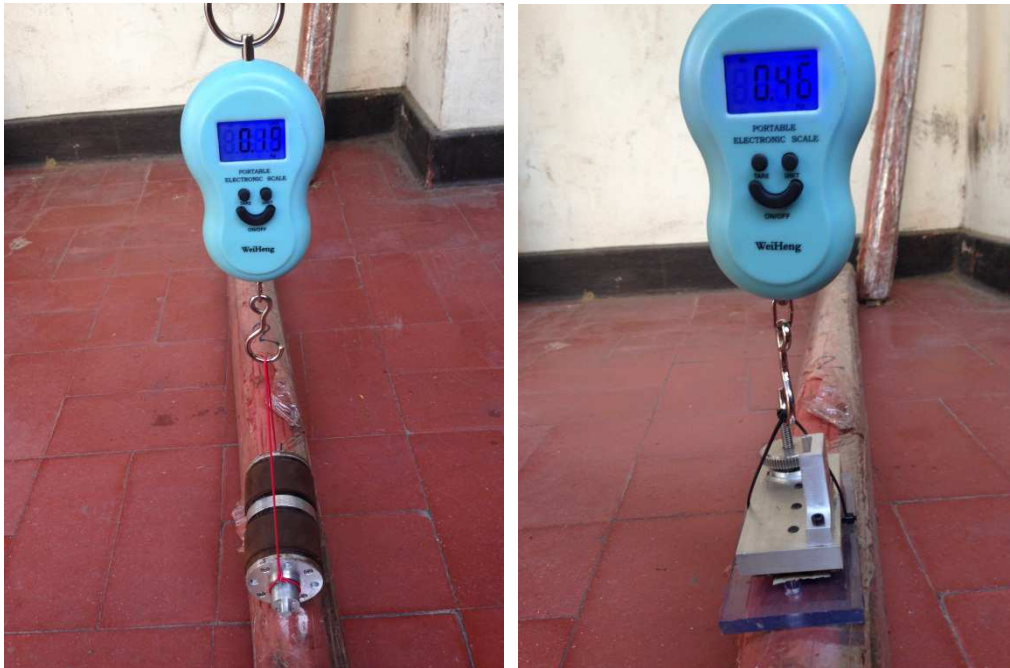
รูปที่ 5.2 การวัดแรงยึดเกาะของชุดเคลื่อนที่แนวขวาง (ก) ล้อแม่เหล็ก (ข) แผ่นเหล็กถูกขึ้นด้วยพลาสติกขนาด 6 มม. เพื่อให้ได้แรงดึงเสมือนติดบนหุ่นยนต์
