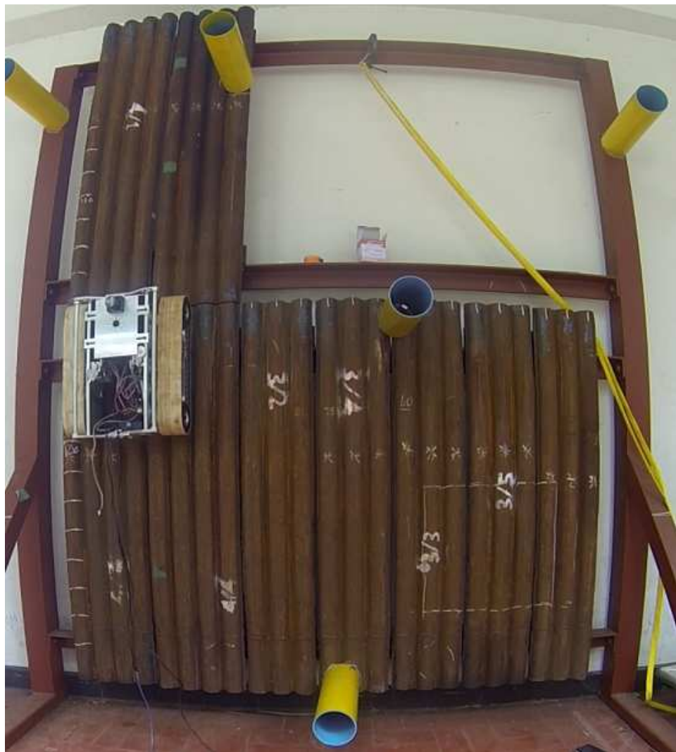
รูปที่ 5.4 หุ่นยนต์สำรวจหม้อไอน้ำขณะติดอยู่กับฐานทดสอบท่อผนัง
