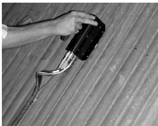
รูปที่ 2.3 เซนเซอร์วัดความหนาเหล็ก (EMAT)[2]
