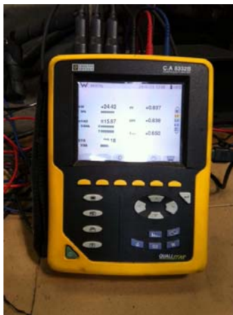
รูปที่ 3.1 แสดงเครื่องพาวเวอร์มิเตอร์ ยี่ห้อ CHAUVIN ARNOUX
