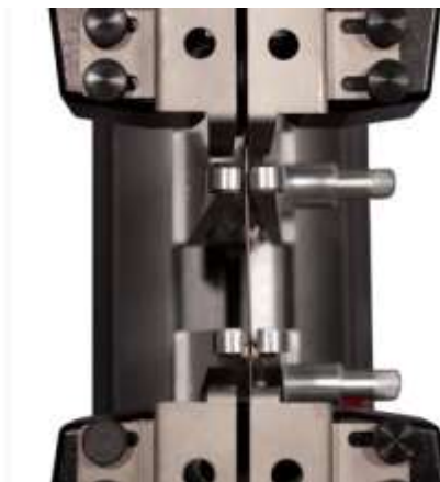
รูปที่ 15 การทดสอบ Tensile testing กับเส้นลวด
