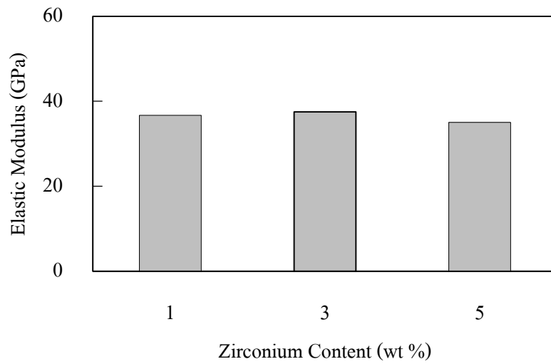
รูปที่ 51 ค่า Elastic Modulus ของชิ้นงานทดสอบ Ti-33Nb-2Ta-(1-5)Zr-0.5O (wt %) ที่ผ่านการรีดเย็นที่ 90%
