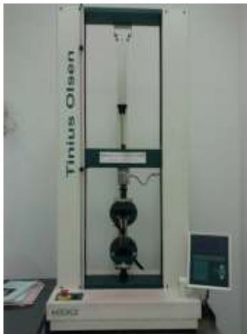
รูปที่ 40 เครื่องทดสอบ Universal Tensile Testing ยี่ห้อ Tinius Olsen รุ่น H50KS
