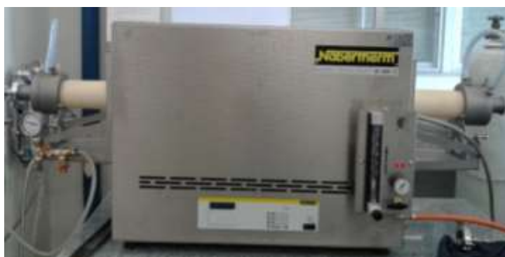
รูปที่ 35 เตาอบสุญญากาศหือ Nabertherm รุ่น RHTC 80-450/15
