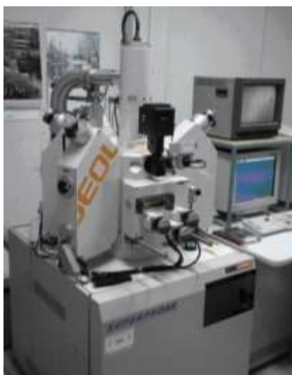
รูปที่ 38 เครื่อง Electron Probe Micro Analyzer ยี่ห้อ JEOL รุ่น JXA-8100
