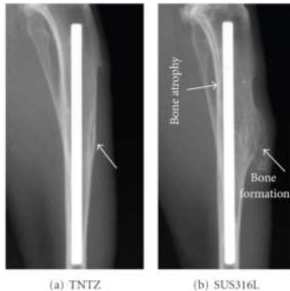
รูปที่ 6 การสร้างกระดูกใหม่ที่ผิดปกติจากการทดลองในกระต่ายเป็นเวลา 24 สัปดาห์ โดยใช้โลหะผสมไทเทเนียมที่มีค่ามอดูลัสความยืดหยุ่นประมาณ 60 GPa(รูป a) เปรียบเทียบกับเหล็กกล้าไร้สนิมเกรด SUS316L ที่มีมอดูลัสความยืดหยุ่นประมาณ 180 GPa(รูป b)[3]
