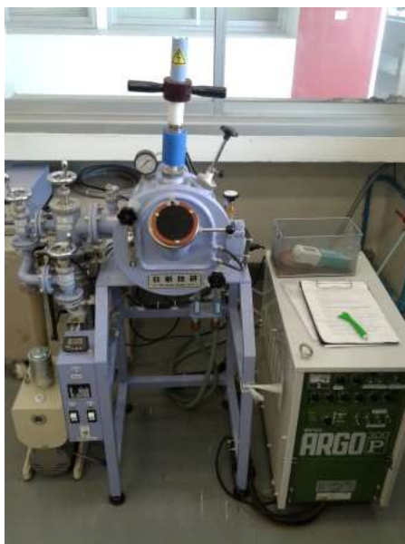
รูปที่ 34 เครื่องหลอมสุญญากาศหือ Nisshin Giken
