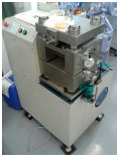
รูปที่ 36 เครื่องรีดเย็นบริษัท จิรา ไทยเทรอด จำกัด รุ่น KM-01
