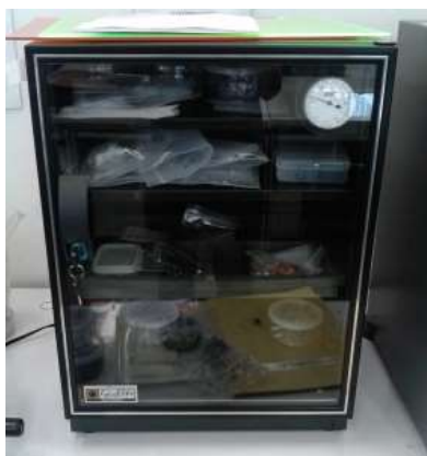
รูปที่ 32 ตู้ควบคุมความชื้นยี่ห้อ Eureka Auto Dry Box รุ่น DX-76
