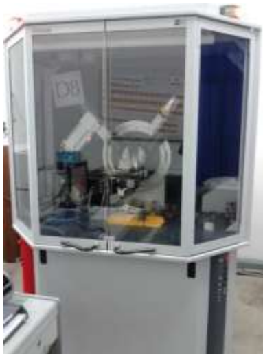
รูปที่ 39 เครื่อง X-Ray Diffractometer ยี่ห้อ Bruker รุ่น D8 Advance
