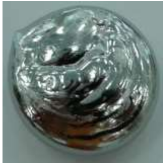
รูปที่ 29 ตัวอย่างชิ้นงานที่ได้จากการหลอมด้วยวิธี Arc Melting
