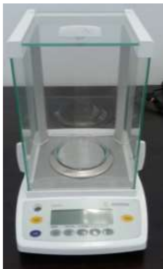
รูปที่ 33 เครื่องชั่งละเอียดหือ Satorius รุ่น ED224S
