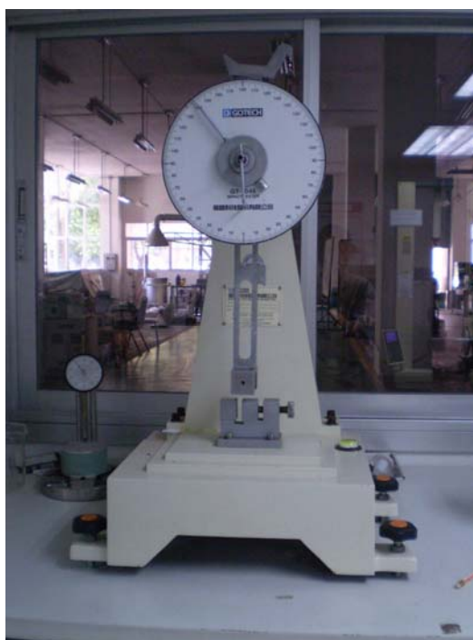
ภาพที่ 14 เครื่อง GOTECH Pendulum Impact tester (Model GT-7045-I)
