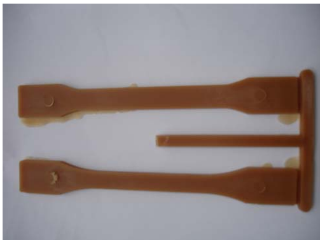
ภาพผนวกที่ ก11 ลักษณะของชิ้นงาน RS 70/LDPE 30 ตามเงื่อนไขการฉีดที่ 5
