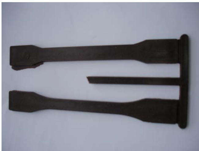
ภาพผนวกที่ ก5 ลักษณะของชิ้นงาน RC 70/ LDPE 30 จากการฉีดตามเงื่อนไขที่ RC 5
