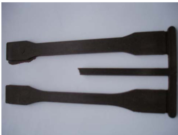
ภาพผนวกที่ ก4 ลักษณะของชิ้นงาน RC 70/ LDPE 30 จากการฉีดตามเงื่อนไขที่ RC 4
