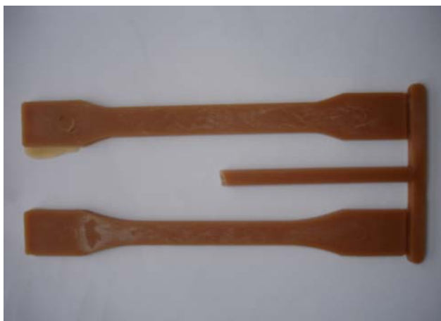
ภาพผนวกที่ ก9 ลักษณะของชิ้นงาน RS 70/LDPE 30 ตามเงื่อนไขการฉีดที่ RS 3
