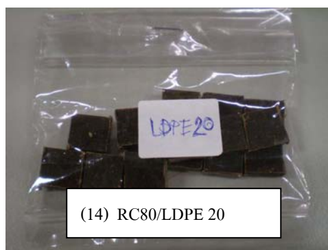
ภาพผนวกที่ ๗ ชิ้นงานก่อนการทดสอบความทนทานต่อสารเคมีของ (13) RC85/LDPE 15 (14) RC80/LDPE 20
