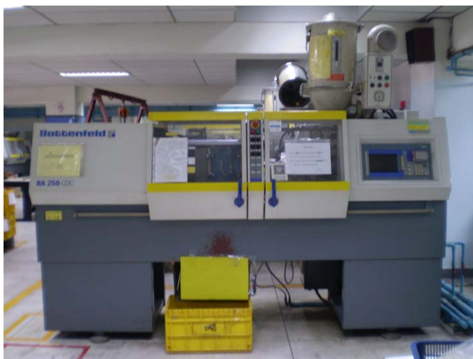
ภาพที่ 11 เครื่องฉีดขึ้นรูปพลาสติก บริษัท Battenfeld Austria รุ่น BA 250/50 CDC
