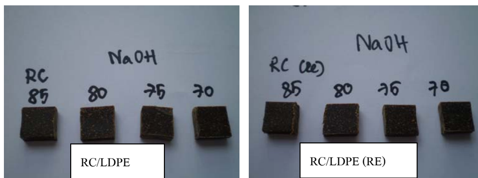
ภาพผนวกที่ 16 ชิ้นงานหลังการทดสอบความทนทานต่อสารละลาย NaOH ของ RC/LDPE กับ RC/LDPE (RE)
