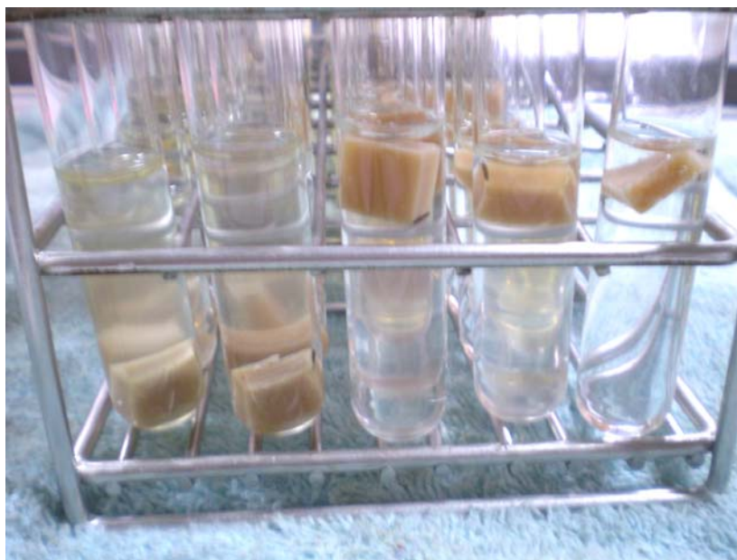
ภาพผนวกที่ 30 การเปลี่ยนแปลงสีในสารละลาย NaOH ของการทดสอบชิ้นงาน RS/LDPE
