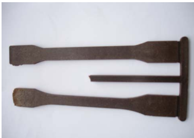
ภาพผนวกที่ ก1 ลักษณะของชิ้นงาน RC 70/ LDPE 30 จากการฉีดตามเงื่อนไขที่ RC 1
