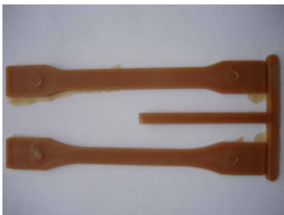
ภาพผนวกที่ ก14 ลักษณะของชิ้นงาน RS 70/LDPE 30 ตามเงื่อนไขการฉีดที่ 8
