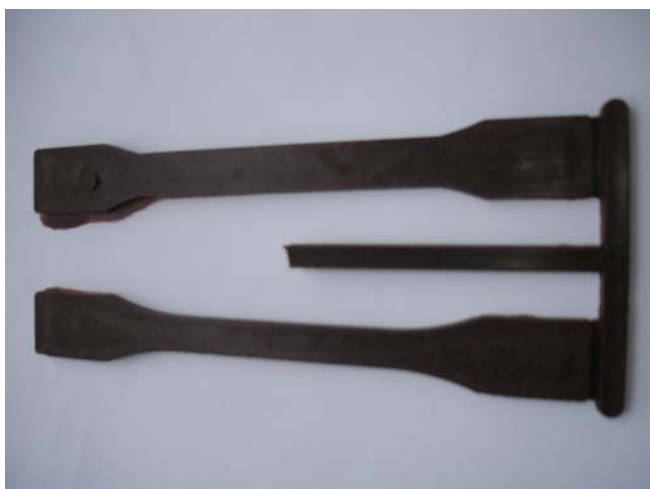
ภาพผนวกที่ ก6 ลักษณะของชิ้นงาน RC 70/ LDPE 30 จากการฉีดตามเงื่อนไขที่ RC 6
