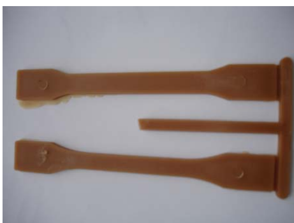
ภาพผนวกที่ ก15 ลักษณะของชิ้นงาน RS 70/LDPE 30 ตามเงื่อนไขการฉีดที่ 9
