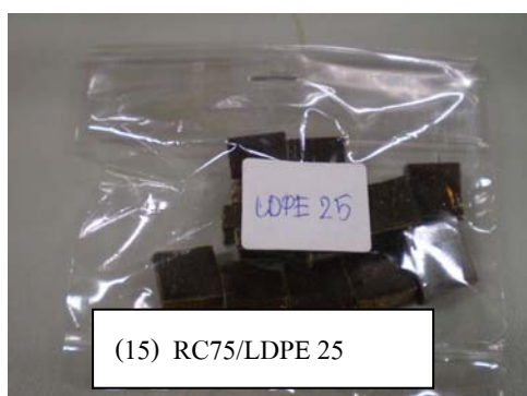
ภาพผนวกที่ ๘ ชิ้นงานก่อนการทดสอบความทนทานต่อสารเคมีของ (15) RC75/LDPE 25 (16) RC70/LDPE 30
