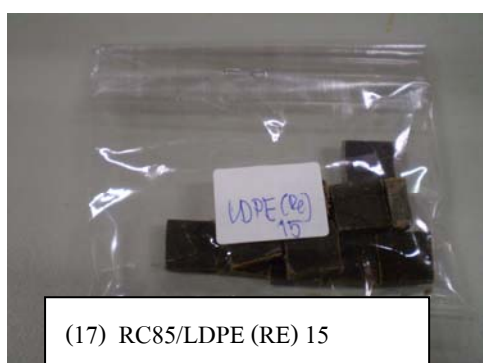
ภาพผนวกที่ ๙ ชิ้นงานก่อนการทดสอบความทนทานต่อสารเคมีของ (17) RC85/LDPE (RE) 15 (18) RC80/LDPE (RE) 20
