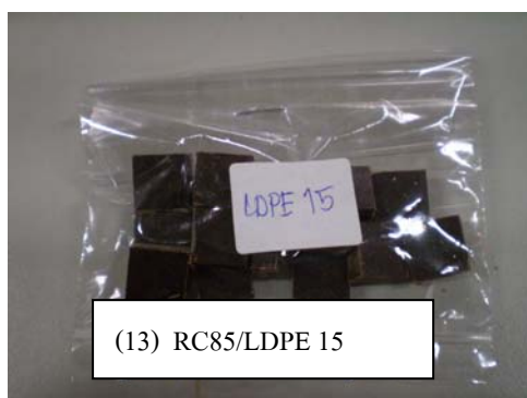
ภาพผนวกที่ ๗ ชิ้นงานก่อนการทดสอบความทนทานต่อสารเคมีของ (13) RC85/LDPE 15 (14) RC80/LDPE 20
