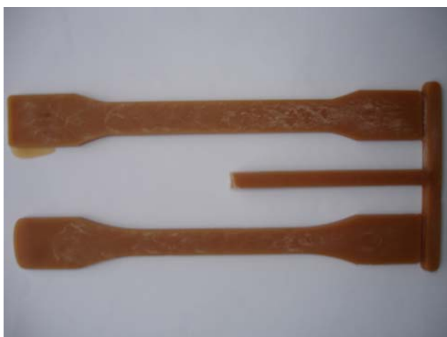
ภาพผนวกที่ ก10 ลักษณะของชิ้นงาน RS 70/LDPE 30 ตามเงื่อนไขการฉีดที่ RS 4
