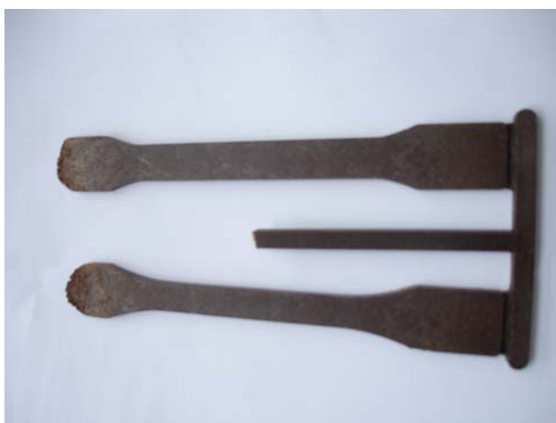
ภาพผนวกที่ ก2 ลักษณะของชิ้นงาน RC 70/ LDPE 30 จากการฉีดตามเงื่อนไขที่ RC 2
