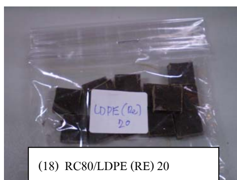
ภาพผนวกที่ ๙ ชิ้นงานก่อนการทดสอบความทนทานต่อสารเคมีของ (17) RC85/LDPE (RE) 15 (18) RC80/LDPE (RE) 20
