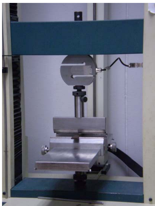
ภาพที่ 15 เครื่อง Hounsfield Universal Testing Machine Model H50K-S
