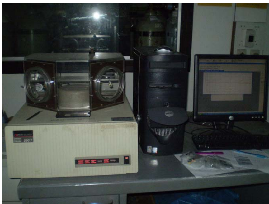
ภาพที่ 17 เครื่องแคลอริเมตรีแบบส่องกราดอนุพันธ์ (Differential scanning calorimetry, DSC) บริษัทPerkin Elemer รุ่นmodel DSC7
