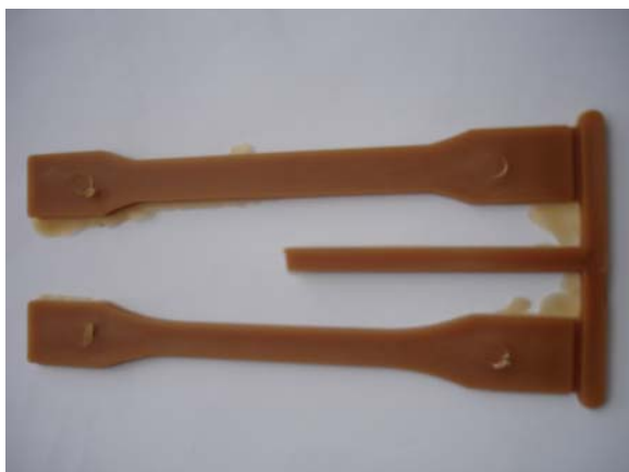
ภาพผนวกที่ ก13 ลักษณะของชิ้นงาน RS 70/LDPE 30 ตามเงื่อนไขการฉีดที่ 7
