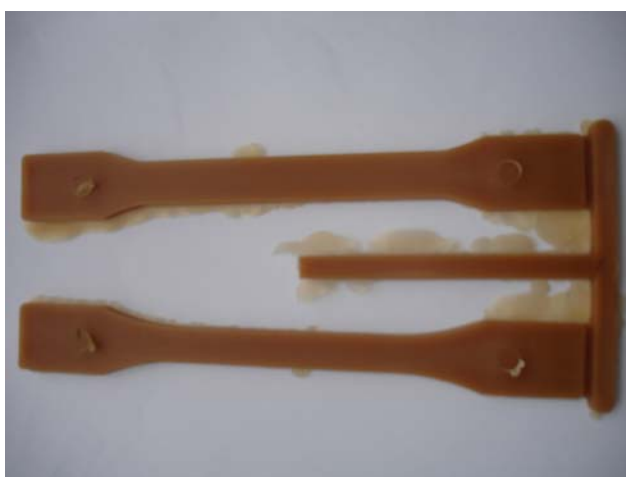
ภาพผนวกที่ ก12 ลักษณะของชิ้นงาน RS 70/LDPE 30 ตามเงื่อนไขการฉีดที่ 6
