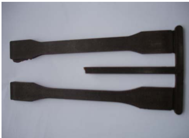
ภาพผนวกที่ ก3 ลักษณะของชิ้นงาน RC 70/ LDPE 30 จากการฉีดตามเงื่อนไขที่ 3
