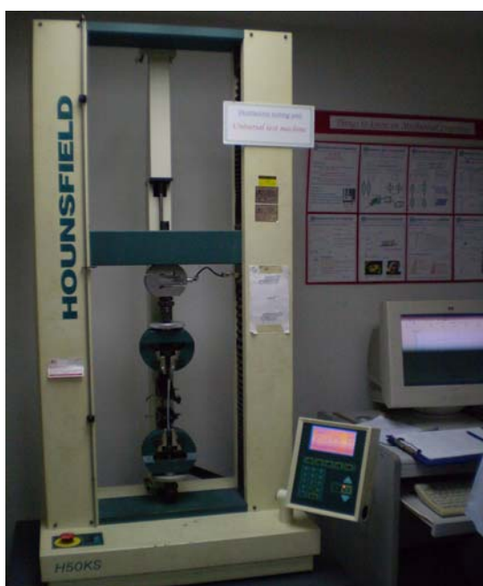
ภาพที่ 12 เครื่อง Hounsfield Universal Testing Machine Model H50K-S
