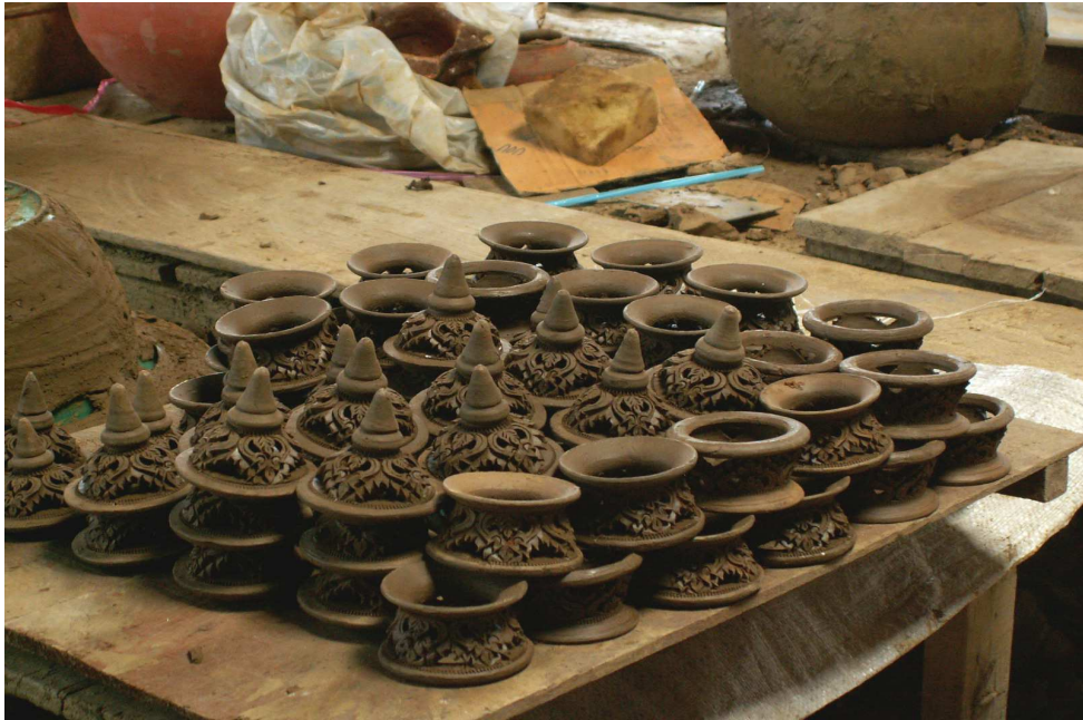
ภาชนะที่แกะสลักลงลายเสร็จ จะนำไปฟiring ประมาณ 1 สัปดาห์ก่อนนำเข้าเตาเผา
