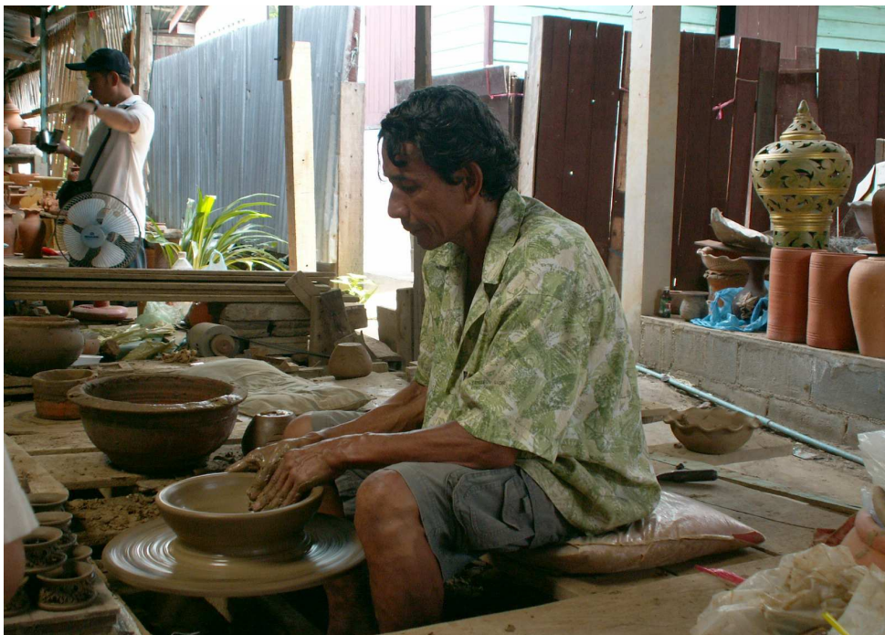
ดินที่ผ่านการนวดแล้ว นำมาปั้นขึ้นรูปเพื่อทำเป็นภาชนะต่างๆ
