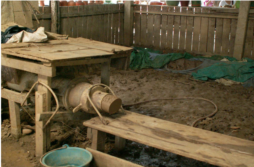
เครื่องนวดดินเพื่อคลุกเคล้าดินให้เข้ากันและมีความเหนียวพร้อมสำหรับการปั้น
