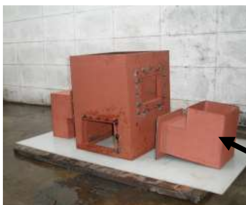
รูปที่ 4.3 ห้องแก๊สเชื้อเพลิงไหลออกไปยังห้องเผาไหม้
