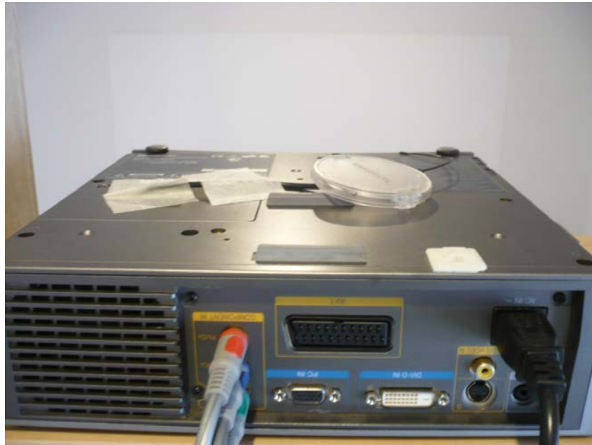
รูปที่ ภาพการเชื่อมต่อสัญญาณภาพความละเอียดสูงด้วยจุดต่อแบบคอมพิวเตอร์
