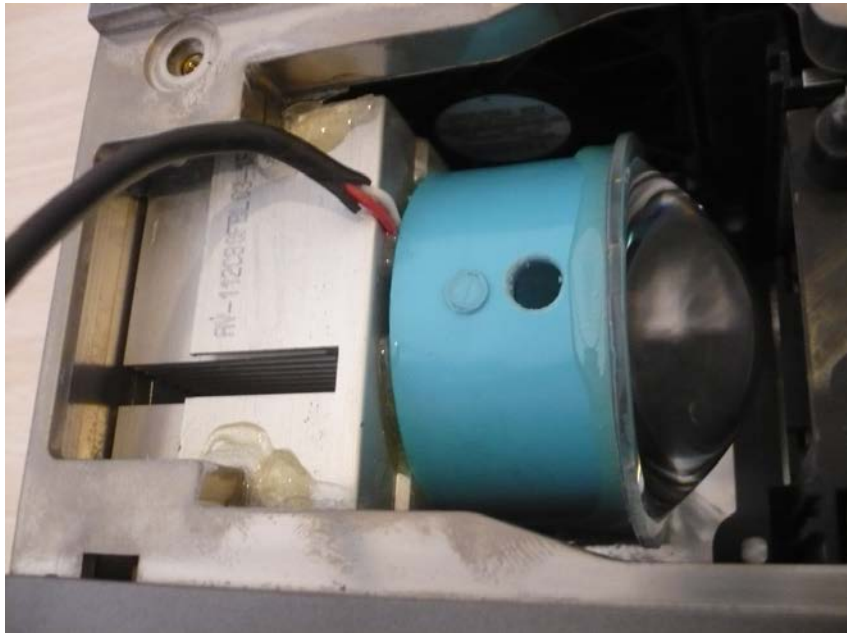
รูปที่ ชุดแหล่งกำเนิดแสงแบบ LED ที่ติดตั้งเลนส์ควบแน่นแสงและระบบระบายความร้อนแล้ว
