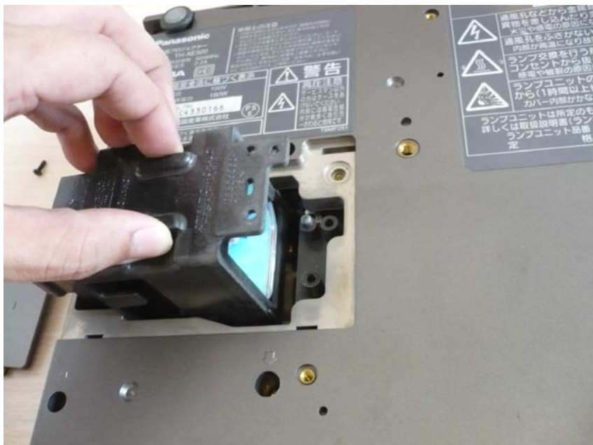
รูปที่ ตำแหน่งของแหล่งกำเนิดแสงของเครื่องฉายภาพยนตร์ภายในบ้าน
