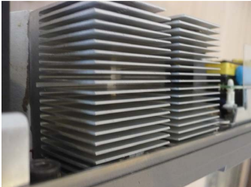
รูปที่ ฮีทซิงค์อลูมิเนียมที่ใช้สำหรับระบายความร้อนของแหล่งกำเนิดแสงแบบ LED
