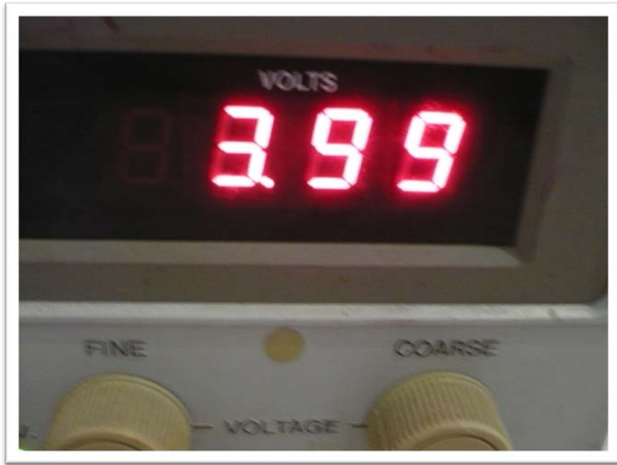
ภาพที่ 3.6 ภาพการจ่ายแรงดันให้ชุดวงจรขับแหล่งกำเนิดแสงแบบ LED ที่ประมาณ 4 โวลต์
