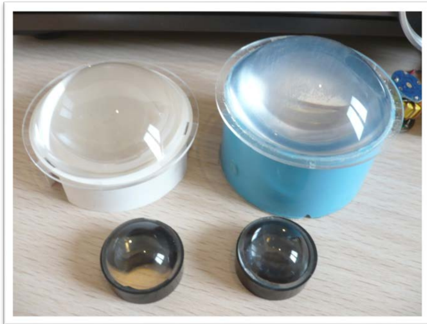
ภาพที่ 3.3 เลนส์ความเข้มแสงขนาดต่างๆที่ใช้ทดลอง
