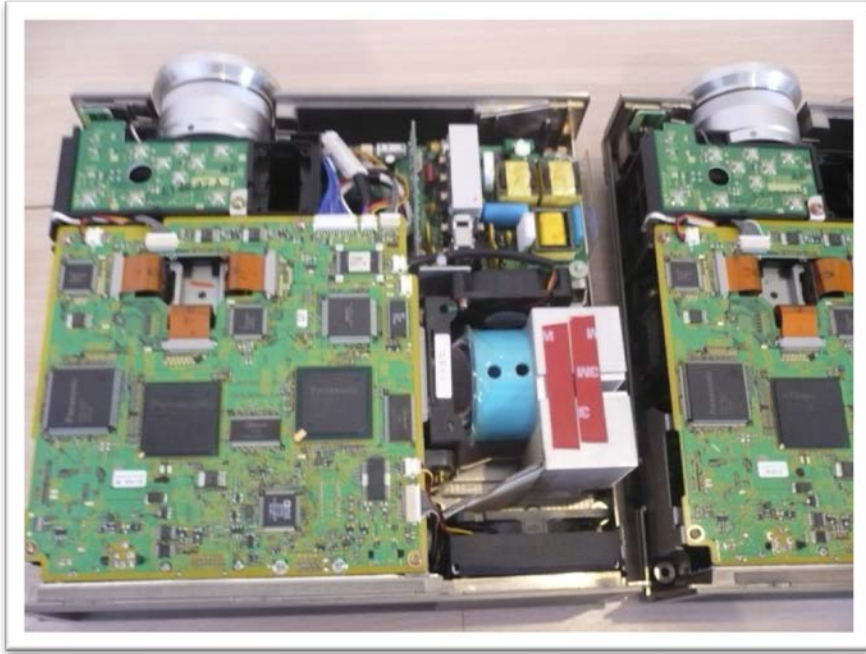
ภาพที่ 3.10 วงจรภายในและตำแหน่งของแหล่งกำเนิดแสงแบบ LED ในเครื่องฉาย
