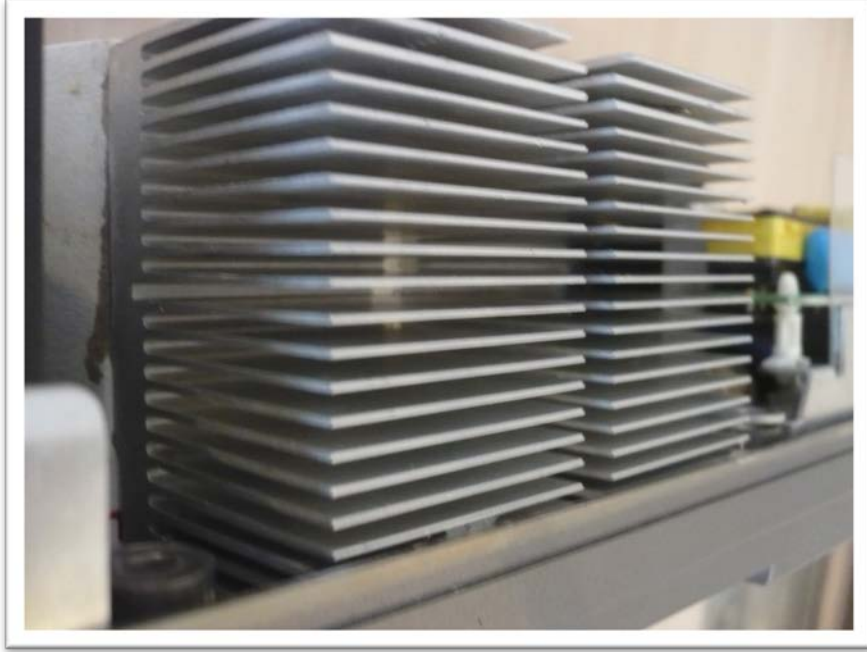
ภาพที่ 3.14 ฮีทซิงค์อลูมิเนียมที่ใช้สำหรับระบายความร้อนของแหล่งกำเนิดแสงแบบ LED
