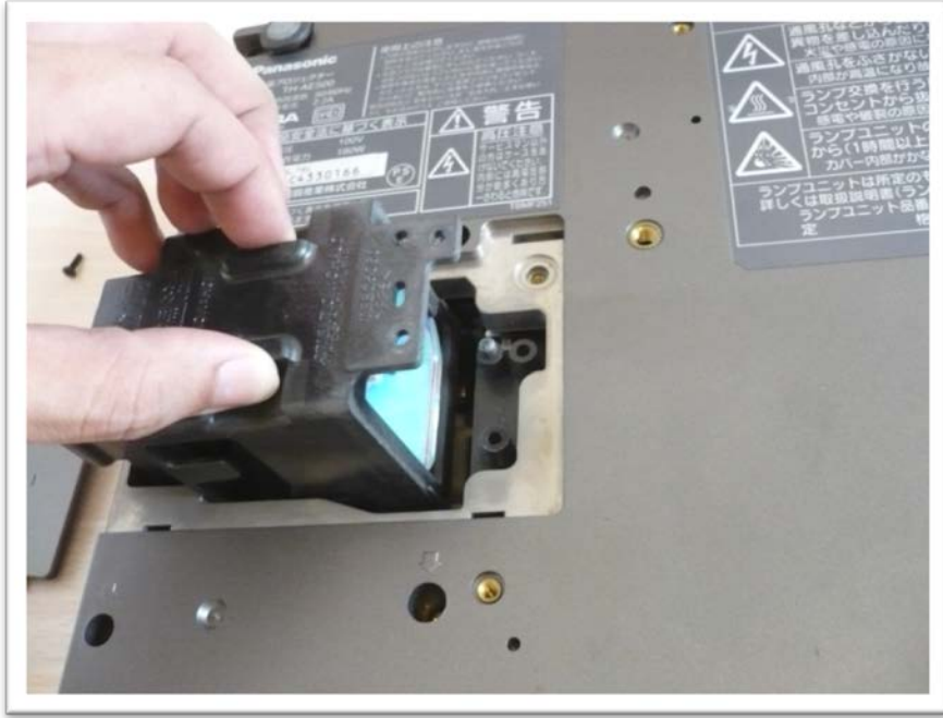
ภาพที่ 3.4 ตำแหน่งของแหล่งกำเนิดแสงของเครื่องฉายภาพยนตร์ภายในบ้าน
