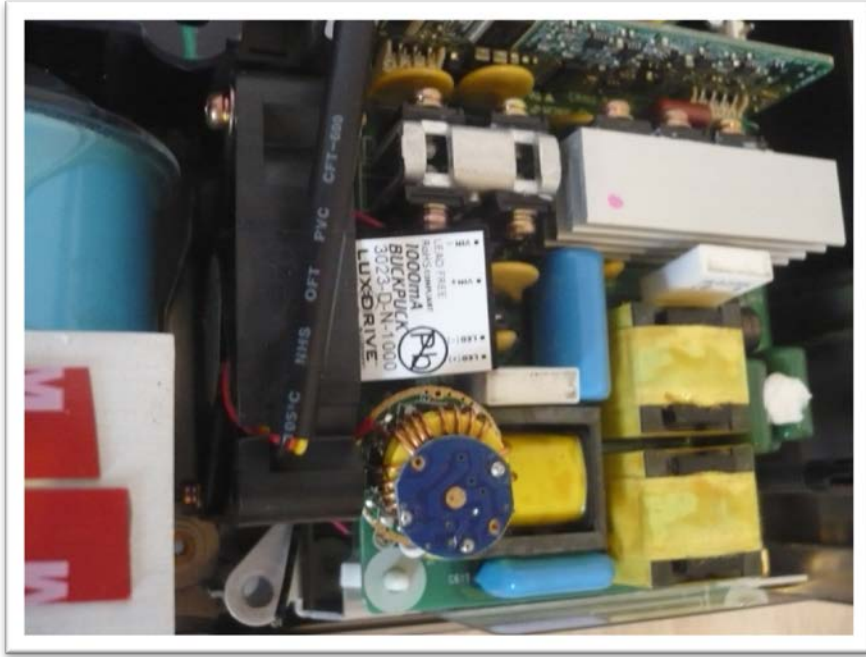
ภาพที่ 3.16 ตำแหน่งติดตั้งของชุดวงจรขับแหล่งกำเนิดแสงแบบ LED
