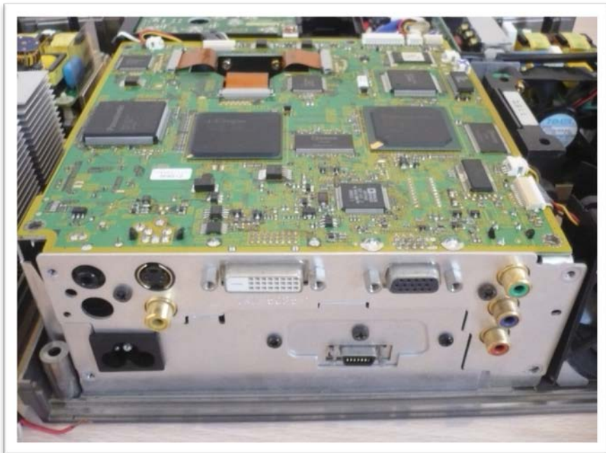
ภาพที่ 3.17 วงจรภายในของเครื่องฉายต้นแบบ
