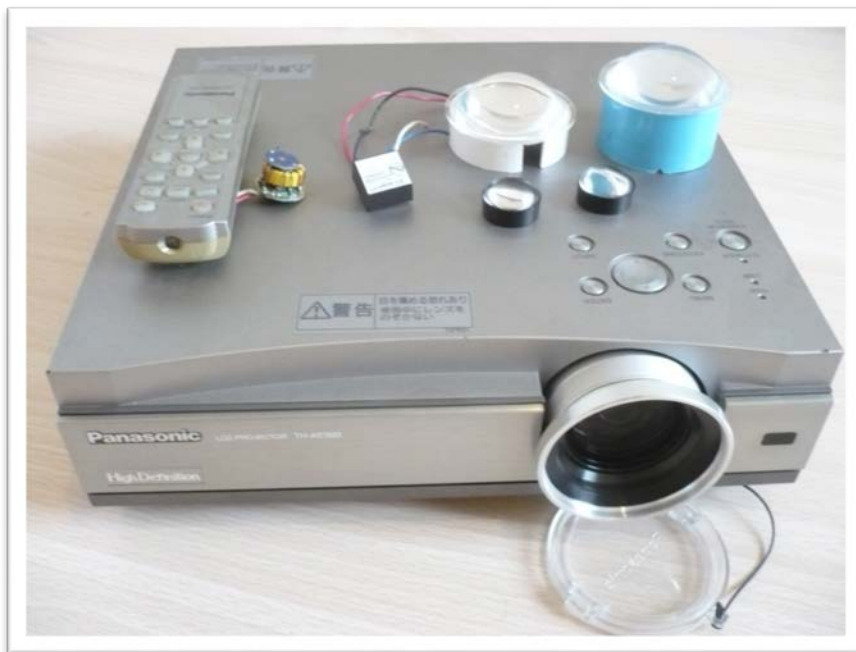
ภาพที่ 3.1 เครื่องฉายใช้แล้วที่นำมาดัดแปลงเป็นเครื่องฉายต้นแบบโดยใช้แหล่งกำเนิดแสง LED
