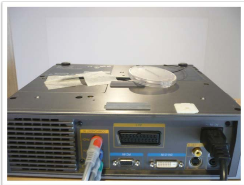
ภาพที่ 3.5 ภาพการเชื่อมต่อสัญญาณภาพความละเอียดสูงด้วยจุดต่อแบบคอม โปเน้นท์
