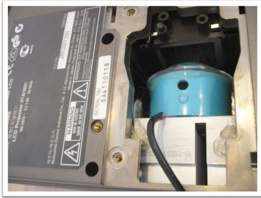
ภาพที่ 3.8 ตำแหน่งติดตั้งแหล่งกำเนิดแสงแบบ LED
