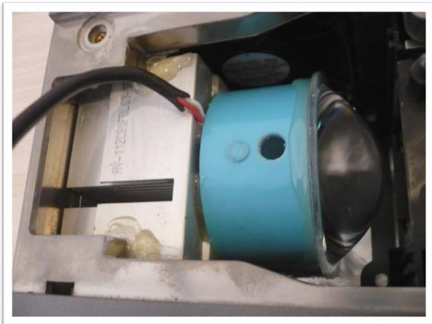
ภาพที่ 3.7 ชุดแหล่งกำเนิดแสงแบบ LED ที่ติดตั้งเลนส์ควมแน่นแสงและระบบระบายความร้อนแล้ว
