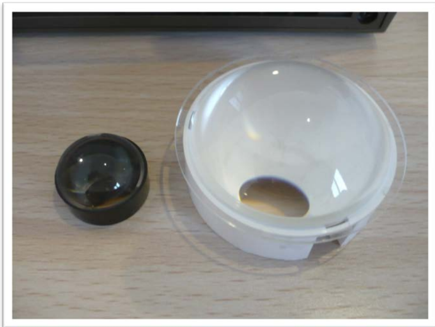
ภาพที่ 3.15 เลนส์ควมแน่นแสงที่ใช้สำหรับแหล่งกำเนิดแสงแบบ LED
