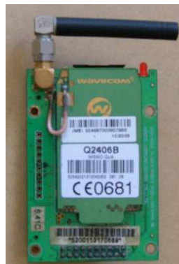
ภาพที่ 3.4 โมดูลโทรศัพท์มือถือที่ใช้ในงานวิจัย
