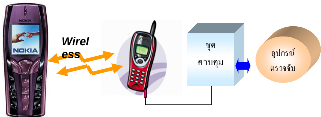
ภาพที่ 2.16 หลักการทำงานเบื้องต้นของเครื่องส่งข้อความเตือนกันขโมยรถยนต์ ที่มา : เณลิมพล คอนนาม และวิชาติ สิทธิรุ่ง. 2548.
