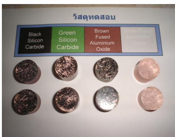
รูปที่ 3.6 เรือนหุ้มวัสดุที่ปรับผิวแล้ว
