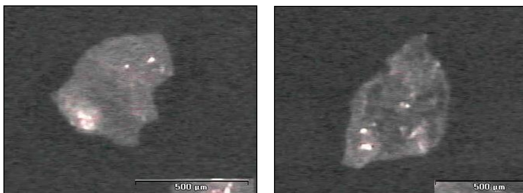
รูปที่ 4.3 ขนาดและรูปร่างต่างๆของ White Fused Aluminium Oxide # 24 Mesh.
