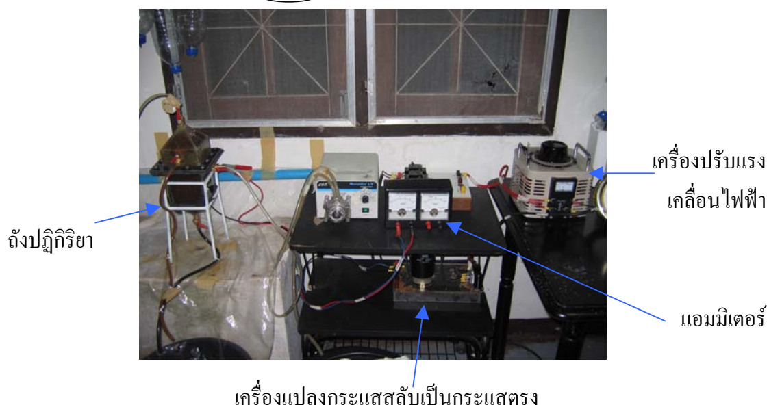
ภาพที่ 13 การต่อวงจรไฟฟ้า และปั๊มสูบน้ำเสียของถังปฏิกริยา ECF
