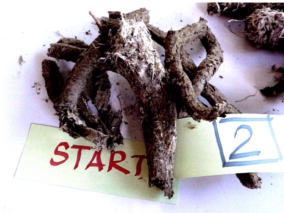
รูปที่ 4.22 การทดลองผลิตขยะเชื้อเพลิงในช่วงเริ่มต้น โดยใช้น้ำในการช่วยประสาน
