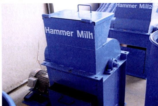
รูปที่ 4.9 เครื่องตัด/ย่อยกิ่งไม้ใบไม้ที่ออกแบบและพัฒนาในโครงการ
