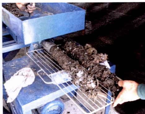
รูปที่ 4.15 การออกแบบและพัฒนาเครื่องอัดแท่งขยะเชื้อเพลิง RDF-5
