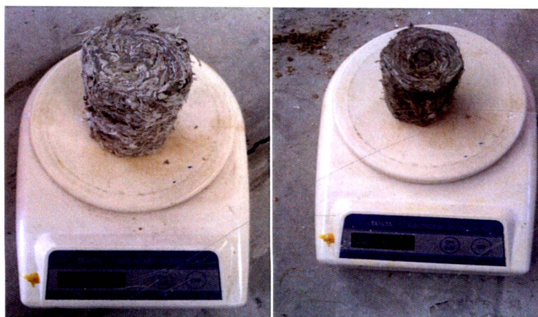
รูปที่ 4.26 การตรวจสอบค่าความหนาแน่นของเชื้อเพลิง RDF-5
