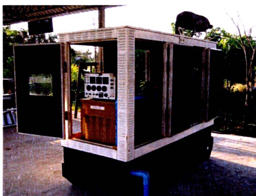
รูปที่ 4.2 เครื่องยนต์ดีเซลผลิตกระแสไฟฟ้าโดยใช้โปรคิวเซอร์แก๊ส
