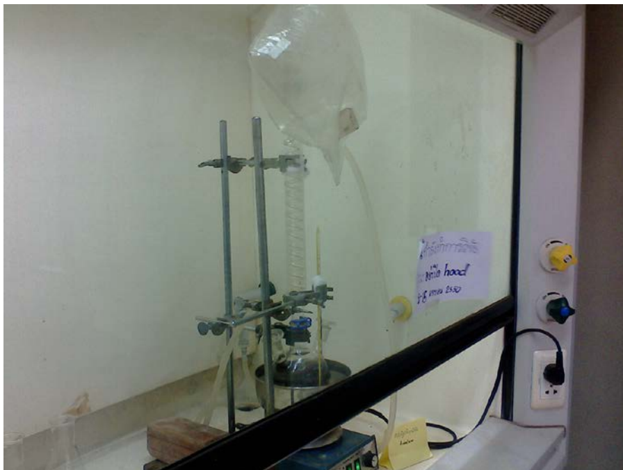
รูปที่ 1ค ชุดการทดลองตอนที่ 1 โดยวิธี oligomerlization
