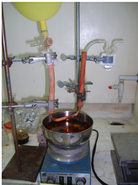
รูปที่ 5ก ชุดการทดลองตอนที่ 2 โดยเทคนิค Copper tube reactor
