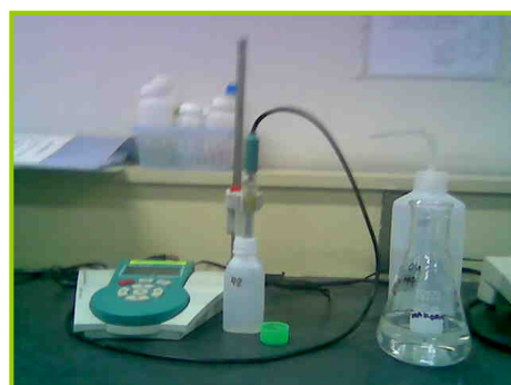
ภาพที่ 21 การศึกษาทดลองแบบไม่ต่อเนื่องในการหาระยะเวลาการดูดซับที่เข้าสู่สมดุลด้วยเครื่องเขย่าและการวัดค่าพีเอช สารละลายตัวอย่างใสโดยเครื่องวัดพีเอชมิเตอร์
