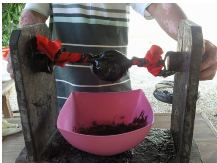
ภาพที่ 16 อุปกรณ์และวิธีการกรองยางรักแบบใหม่
