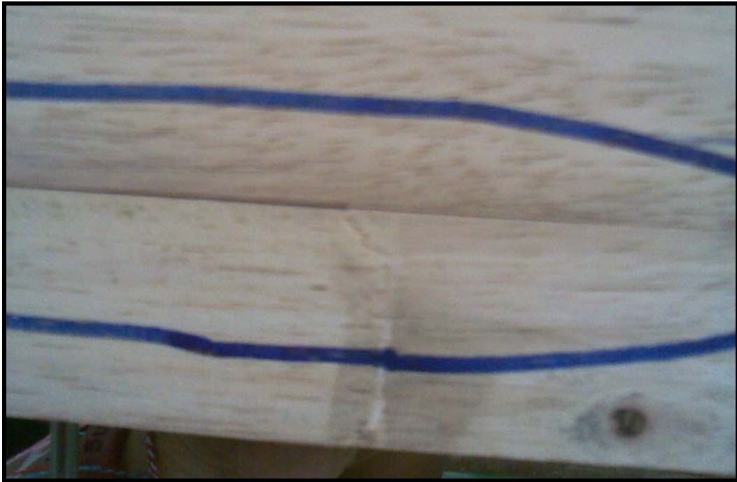
รูปที่ 6.4 รอยแตกร้าวขนาดเล็กที่ด้านรับแรงดึง
