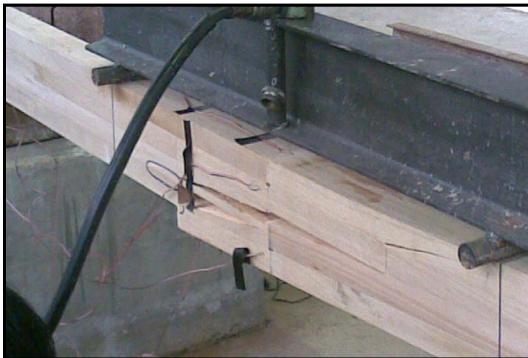
รูปที่ 6.5 การวิบัติของคานไม้ยางพาราประกอบ
