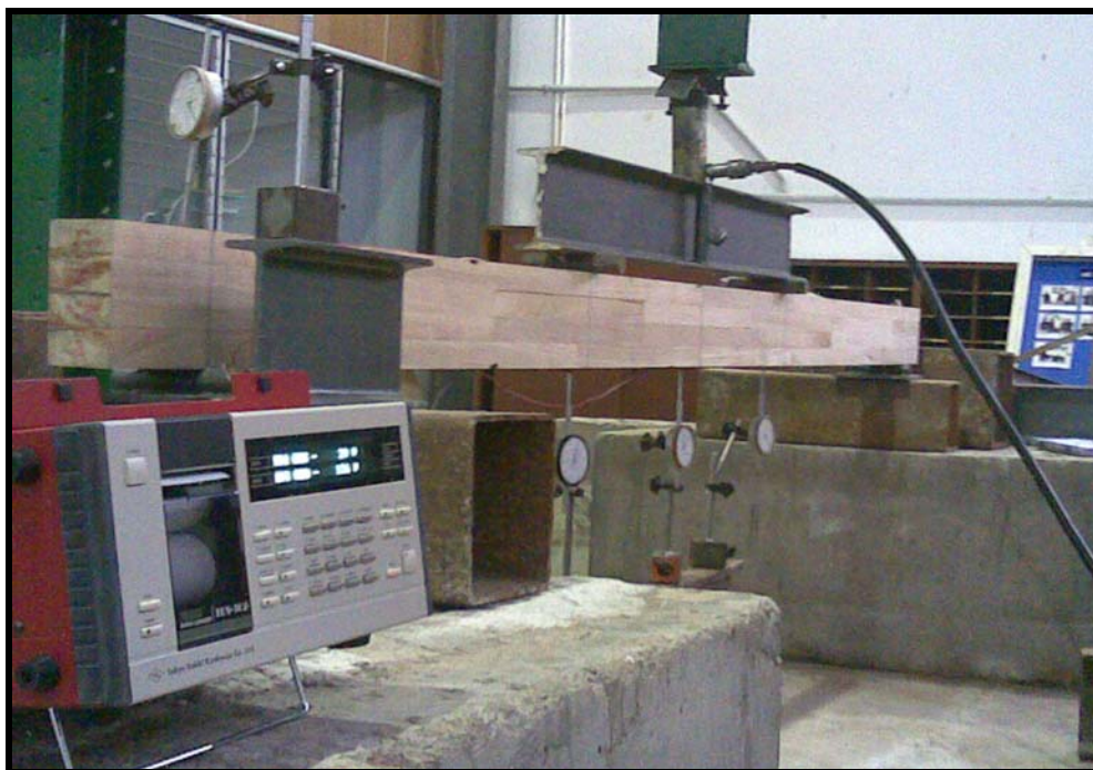
รูปที่ 4.7 การติดตั้งอุปกรณ์และการเตรียมการทดสอบภายใต้การดัด 4 จุด (ASTM D198-97)
