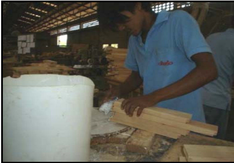
รูปที่ 3.6 การทากาวบริเวณพื้นรอยต่อของท่อนไม้เพื่อใช้ประกบ
