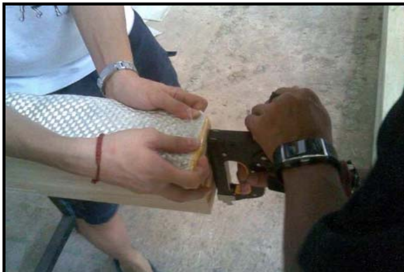
รูปที่ 3.16 การยึดแผ่นเส้นใยแก้วในเบื้องต้นเข้ากับคานไม้
