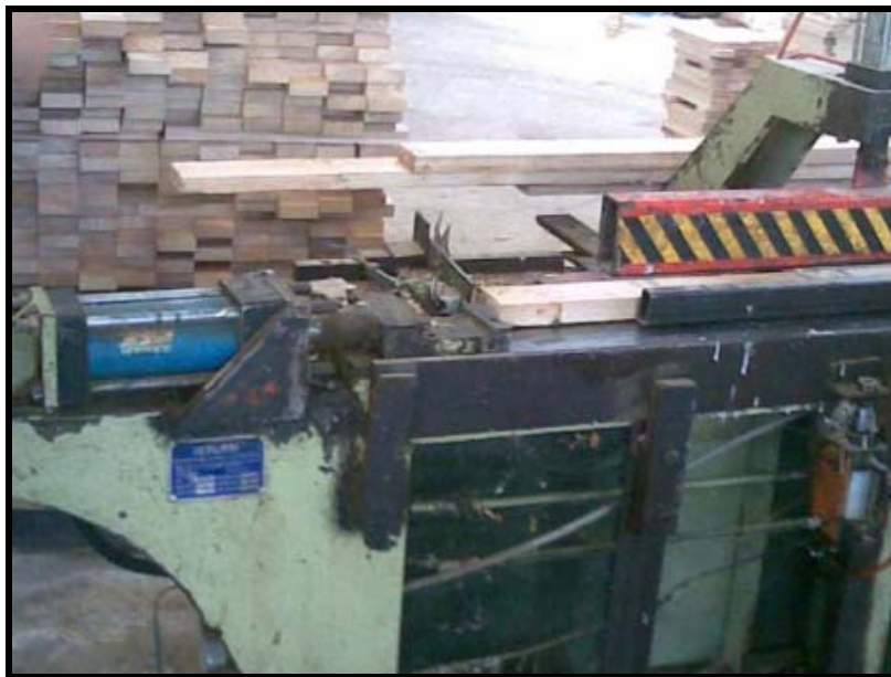
รูปที่ 3.6 การทากาวบริเวณพื้นรอยต่อของท่อนไม้เพื่อใช้ประกบ
