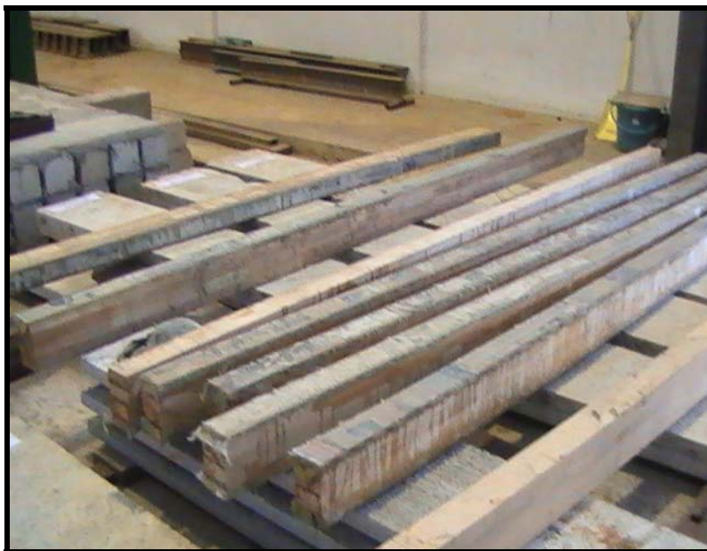
รูปที่ 3.19 คานไม้ยางพาราประกอบที่เสริมกำลังด้วยวัสดุพอลิเมอร์เสริมเส้นใยแก้ว
