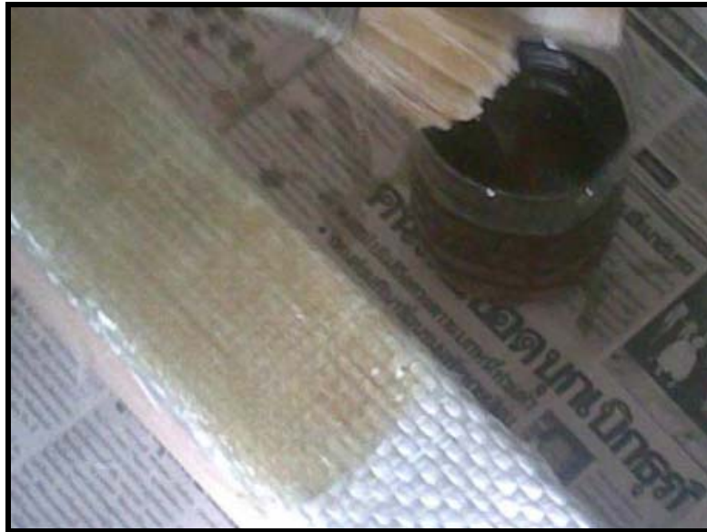
รูปที่ 3.18 การทาพอลิเอสเทอร์บนแผ่นเส้นใยแก้วที่ติดเหนือผิวของคานไม้ยางพาราประกอบ
