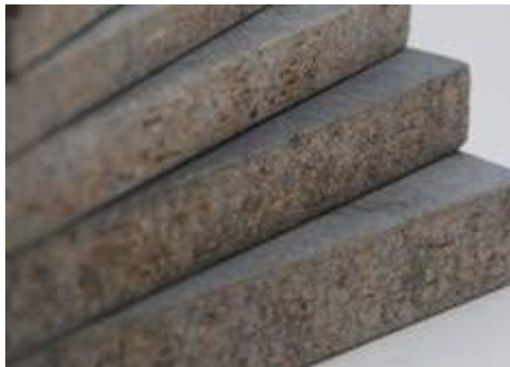
รูปที่ 4.1 ลักษณะทั่วไปของแผ่นใยไม้อัดซีเมนต์จากกากมะพร้าวและเส้นใยต้นข้าวโพด อัตราส่วน CN75
