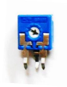
รูปที่ 2.21 แสดงภาพ Potentiometer อุปกรณ์วัดค่ามุมที่เปลี่ยนแปลงของชุดควบคุมส่วนแขน
