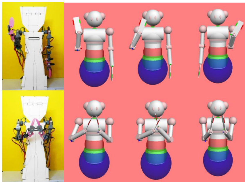
รูปที่ 3.6 แสดงท่าโบกมือลา (แถวบน) และท่าไหว้ (แถวล่าง) ของแบบจำลองหุ่นยนต์เซมิฮิวมานอยด์ เมื่อควบคุมแบบ Joint Control
