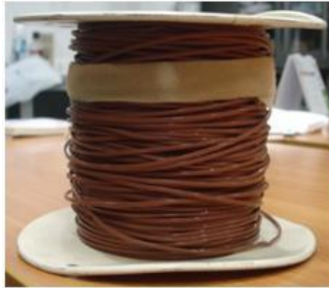
รูปที่ 3.8 สายเทอร์โมคัปเปิล (Thermocouple)
