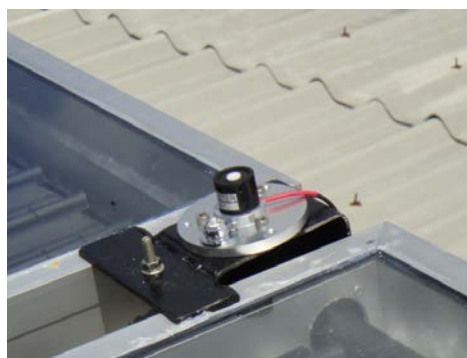
รูปที่ 3.7 ไพรานอมิเตอร์ (Pyranometer)
