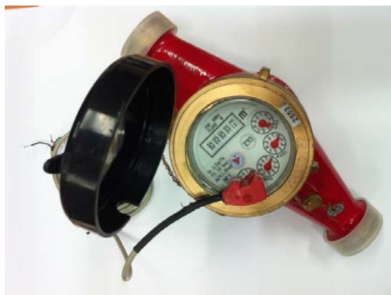
รูปที่ 3.9 เครื่องวัดอัตราการไหล (Flow Meter)
