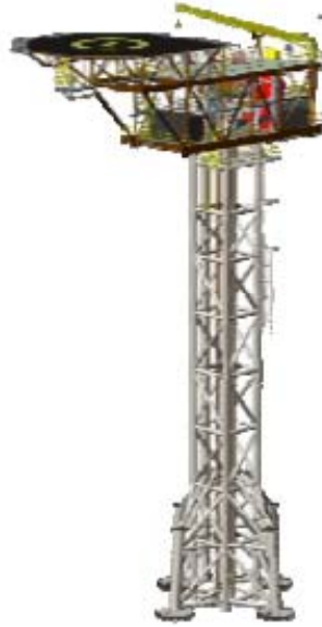
รูปที่ 2.5 โครงสร้างนอกชายฝั่งทะเลขนาดเล็กแบบ 4 ขา (Tetra-pod) [7]
