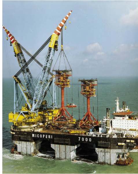
รูปที่ 2.3 ตัวอย่างการติดตั้ง โครงสร้างนอกชายฝั่งทะเลขนาดเล็กแบบเสาเดี่ยวที่มีค้ำยัน [9]
