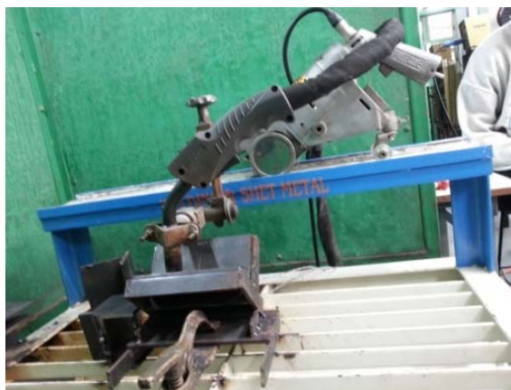
รูปที่ 3.2 ชุดอุปกรณ์ควบคุมการเชื่อมแบบอัตโนมัติ TANAKA รุ่น KT-160
