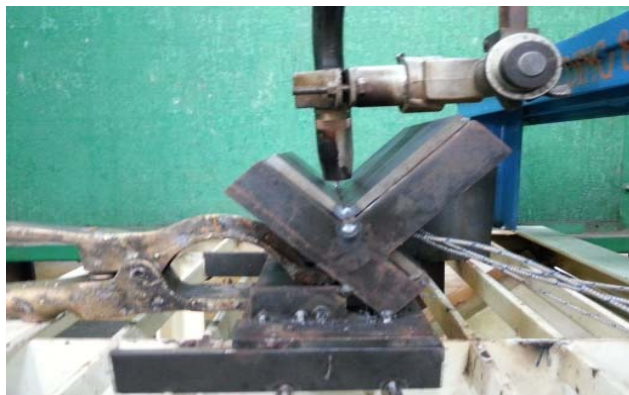
รูปที่ 3.14 การติดตั้งชิ้นงานก่อนเชื่อม
