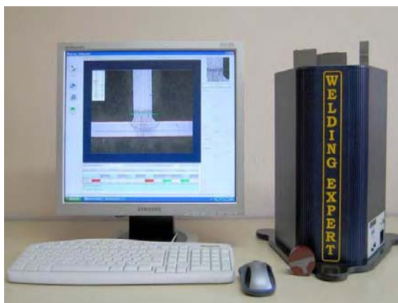
รูปที่ 3.10 เครื่องตรวจสอบการบิดงอเชิงมุมและการหลอมลึก
