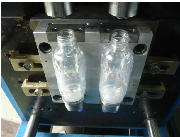
ภาพที่ 3-17 เปิดแม่พิมพ์เป่า
