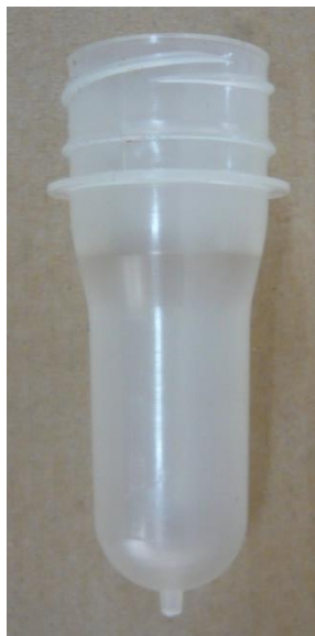
ภาพที่ 3-13 프리ฟอร์ม(Preform) ขนาด15g
