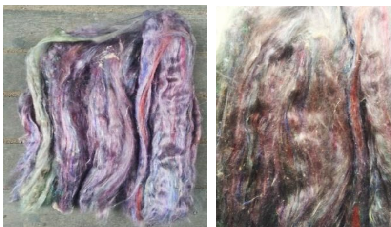
ภาพที่ 3.5 เศษวัสดุเหลือทิ้งที่ผ่านเข้าเครื่อง CARDING ในรูปแบบของเส้น SLIVER
