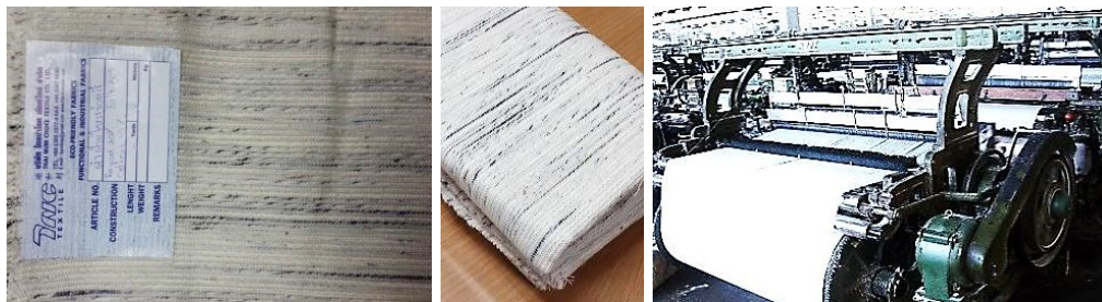
ภาพที่ 3.9 ผืนผ้าสำเร็จที่ผ่านกระบวนการทอแบบโรงงานอุตสาหกรรมด้วยเศษวัสดุเหลือทิ้งจากเศษเส้นใยไหมผสมฝ้าย ในอัตราส่วน 50 : 50
