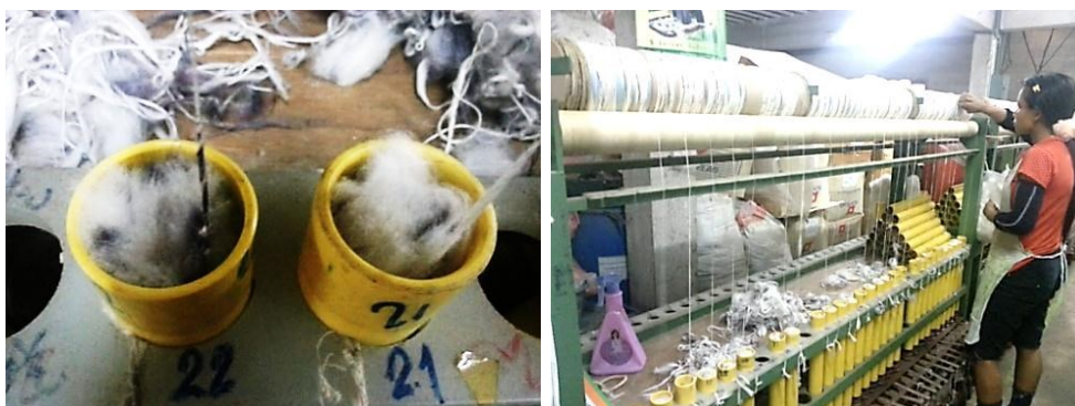
ภาพที่ 3.7 การนำเส้นใย SLIVER ทั้งสองชนิดเข้ากระบวนการปั่นเป็นเส้นด้ายพิเศษแบบ SLUB YARN
