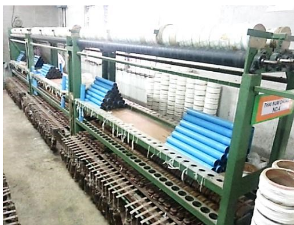
ภาพที่ 3.6 เครื่อง GAREBO ไทยนาโซค สำหรับปั่นเส้นด้ายพิเศษแบบ SLUB YARN
