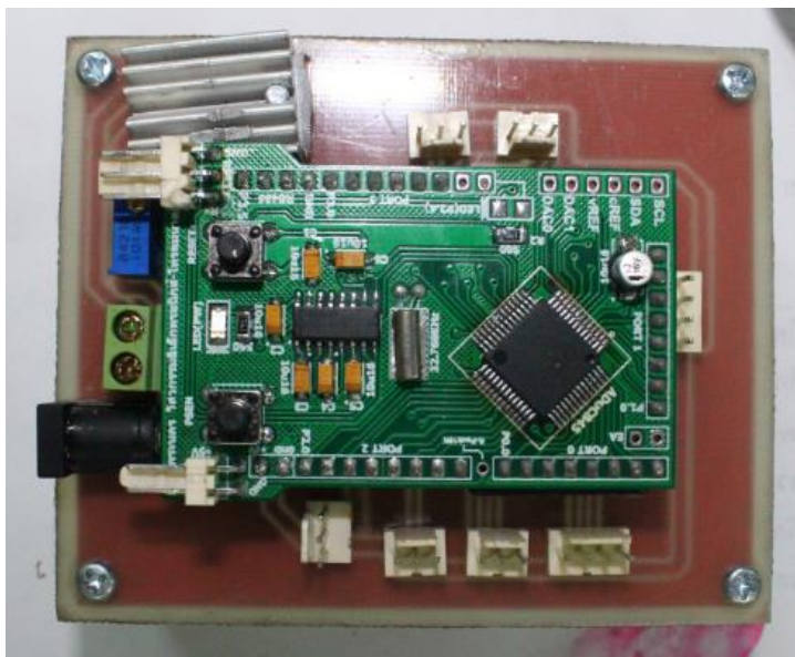
ภาพที่ 3.49 ไมโครคอนโทรลเลอร์บอร์ด ADuC842 ส่วนการวัดค่าการดูดกลืนแสงสารละลาย
