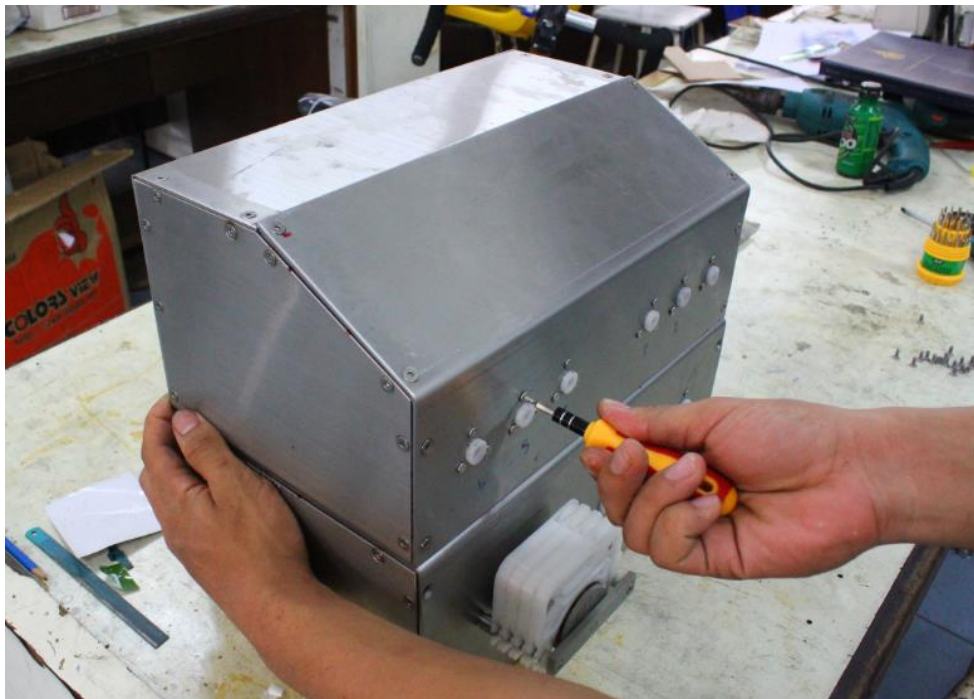
ภาพที่ 3.59 ประกอบข้อต่อสารละลายกับตัวเครื่อง
