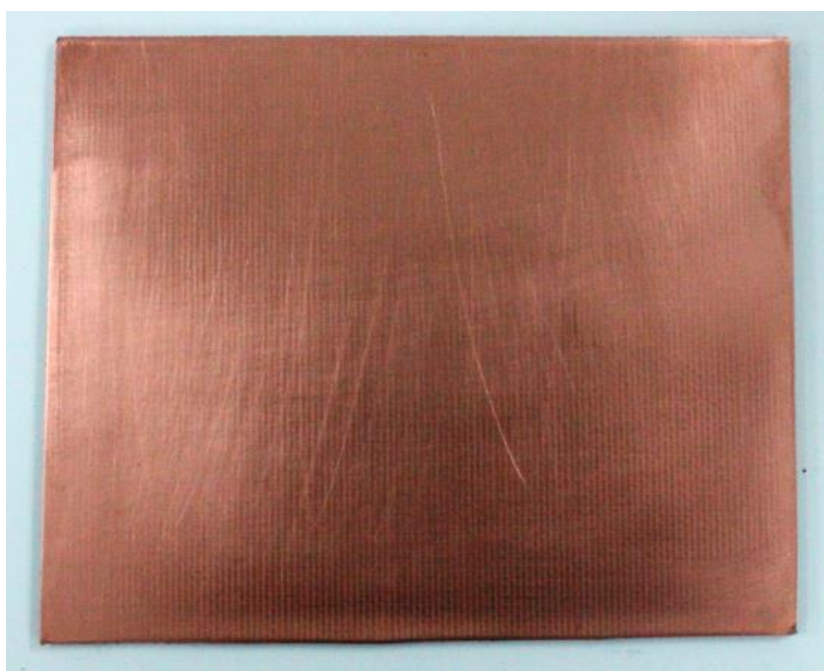
ภาพที่ 3.29 แผ่นปริ๊นท์ที่ตัดเท่าขนาดกระดาษลายทองแดง
