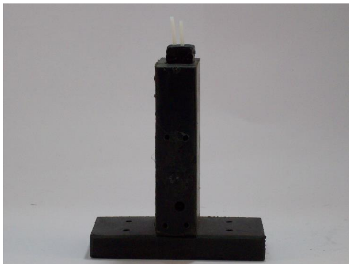
ภาพที่ 3.48 ที่ใส่หลอดคิวเวทในช่องป้องกันแสงรบกวนจากภายนอก
