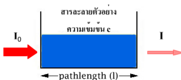
ภาพที่ 2.4 ลำแสงที่ผ่านเข้าออกสารละลายความเข้มข้น C เป็นระยะทาง l
