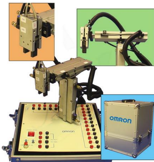
รูปที่ 2.16 แสดงตัวอย่างชุดทดลองระบบควบคุมอัตโนมัติ (ที่มา บริษัท Omron Thailand)
