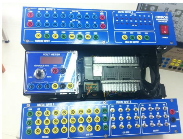
รูปที่ 3.1 PLC ที่มีโมดูลอนาล็อกสำหรับรับค่าสัญญาณควบคุมป้อนกลับ
