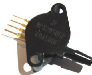
รูปที่ 3.2 เซนเซอร์วัดค่าแรงดันของเหลวเปลี่ยนเป็นสัญญาณไฟฟ้า
