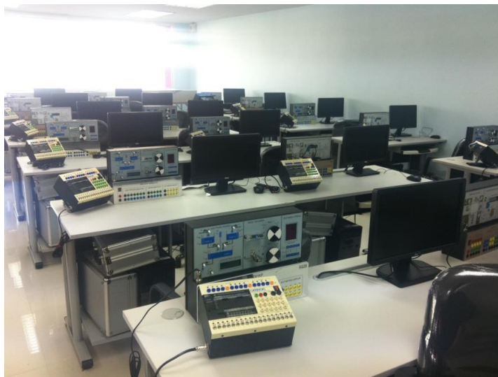
รูปที่ 2.17 ชุดควบคุม PLC มาตรฐานในห้องปฏิบัติการ
