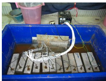
รูปที่ 3-4 การเตรียมตัวอย่างคอนกรีตและการเร่งการเกิดสนิมด้วยกระแสไฟฟ้า
