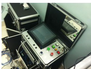
รูปที่ 3-7 การเตรียมอุปกรณ์และเครื่องมือโดยใช้วิธีการส่งคลื่นเพื่อหาความต้านทานโพลาไรซ์
