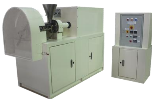
ภาพที่ 1 แสดงเครื่องอัดรีดชนิดสกรูเดี่ยว, Collet (รุ่น D50L300, บ. เจริญทัศน์)
