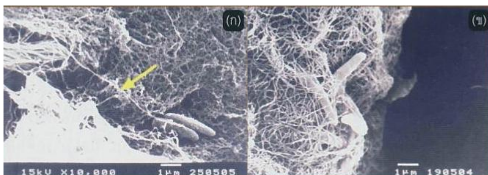
รูปที่ 2.16 เส้นใยเซลลูโลสที่ผลิตโดย A. xylinum เมื่อส่องดูภายใต้กล้องจุลทรรศน์อิเล็กตรอน (กำลังขยาย 10,000 เท่า): (ก) เส้นใยเซลลูโลสที่ถูกปล่อยออกจากเซลล์ (ศรีชี): (ข) เส้นใยเซลลูโลสล้อมรอบ และหุ้มตัวเซลล์ ที่มา : วราวุฒิ (2551)
