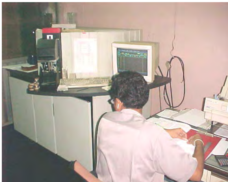
รูปที่ 3.16 การตรวจสอบค่าเคมีในน้ำเหล็ก
