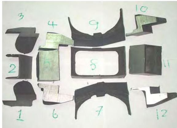
รูปที่ 4.4 สภาพหลังจากผ่าของชิ้นงานที่สภาพภายนอกเป็นของดี
