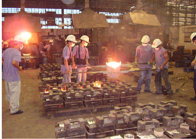
รูปที่ 3.17 การเทน้ำเหล็กลงในแบบทราย
