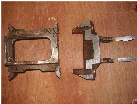
รูปที่ 4.5 สภาพหลังจากผ่าของชิ้นงานที่สภาพภายนอกเป็นของเสีย
