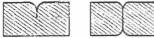
รูปที่ 2.10 ลักษณะของตำหนิเนื้อไม่ประสาน [7]
