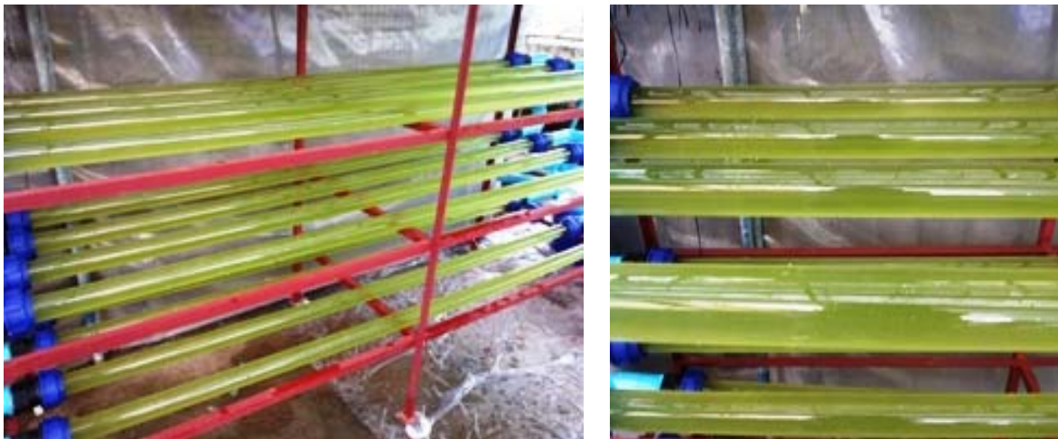
ภาพที่ 4.1 ระบบ horizontal tubular photobioreactor ที่สร้างขึ้นเพื่อใช้ในการเพาะเลี้ยงสาหร่าย
