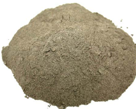
ภาพประกอบที่ 4-1 ลักษณะทางกายภาพของขี้ตะกรันที่ผ่านการอบแห้งและคัดขนาดด้วยการร่อนตะแกรงให้ได้ขนาดอนุภาค 37-44 ไมครอน
