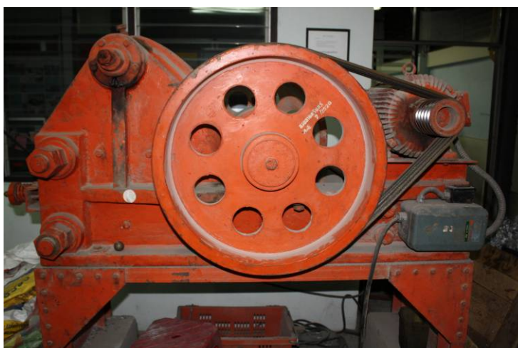
ภาพประกอบที่ 3-2 เครื่องบดย่อยแบบจาว (Jaw Crusher) ใช้สำหรับการบดหยาบจีตะกวน
