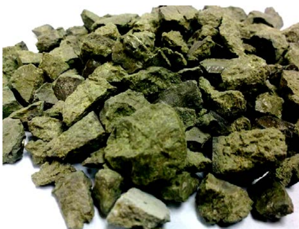
ภาพประกอบที่ 3-1 ลักษณะทางกายภาพของซีตะกรันที่ได้จากเตาอาร์คไฟฟ้า (EAF)
