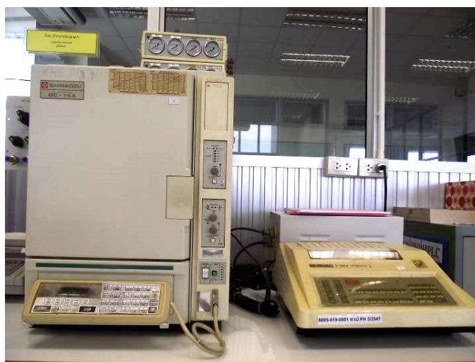
ภาพประกอบที่ 3-15 เครื่องแก๊สโครมาโตกราฟี (Gas Chromatography, GC) สำหรับวิเคราะห์หาความเข้มข้นของก๊าซ \text{CO}_2
