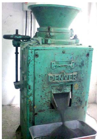
ภาพประกอบที่ 3-3 เครื่องบดย่อยแบบไจราทอรี (Gyratory Crusher)
