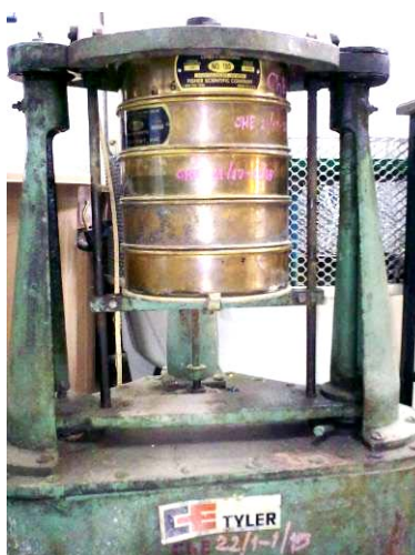
ภาพประกอบที่ 3-4 เครื่องร่อนตะแกรงสำหรับคัดขนาดชิ้นตะกรัน
