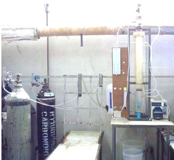
ภาพประกอบที่ 3-13 ชุดการทดลองของคอลัมน์บรรจุที่ใช้ในห้องปฏิบัติการ
