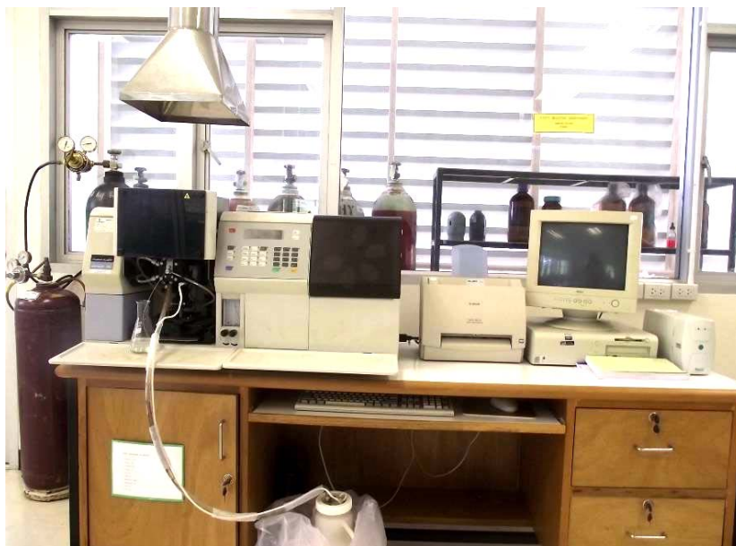
ภาพประกอบที่ 3-7 แสดงเครื่อง Atomic Adsorption Spectrometer (AAS) สำหรับใช้วิเคราะห์ ความเข้มข้นของแคลเซียม
