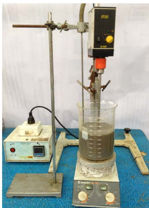
ภาพประกอบที่ 3-9 ชุดอุปกรณ์การทดลองสำหรับถังปฏิกรณ์แบบกะในห้องปฏิบัติการ
