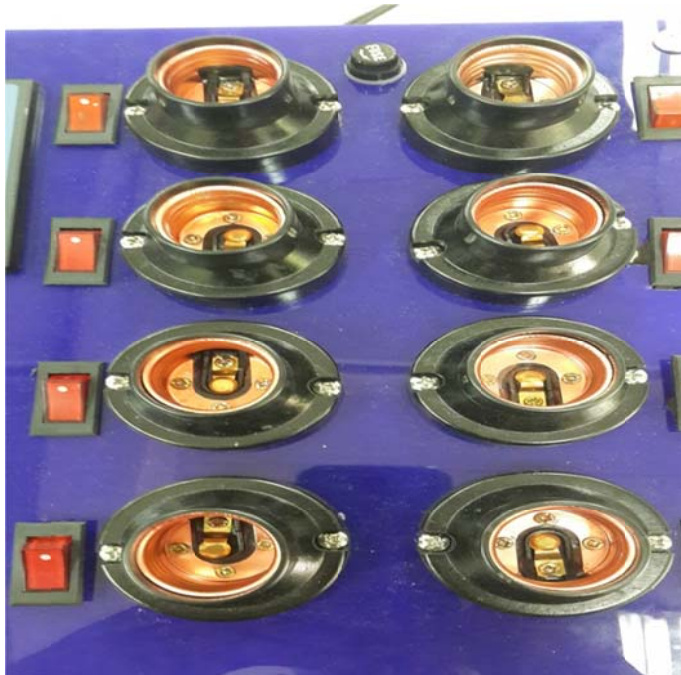
รูปที่ ๓.๔ เจาะรูเพื่อใส่ ติดตั้ง ขั้วหลอดไฟ และอุปกรณ์ต่างๆ ลงในแผงทดลอง
