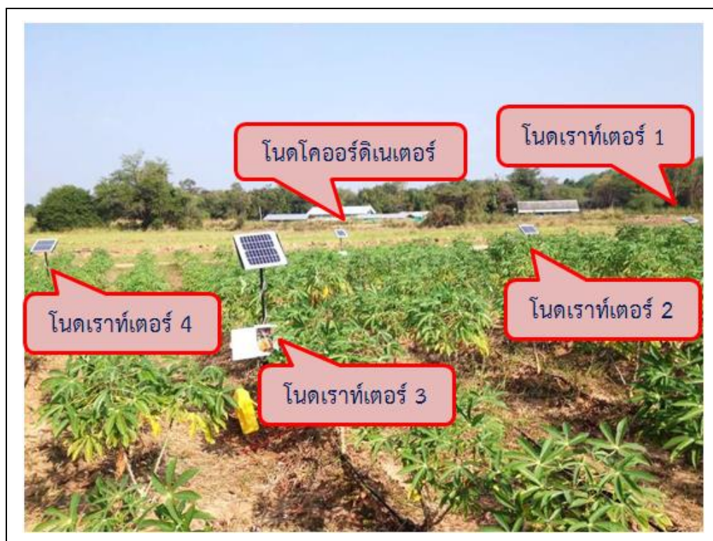
รูปที่ 3.19 การติดตั้งโนตเซนเซอร์ในพื้นที่เพาะปลูกจริง
