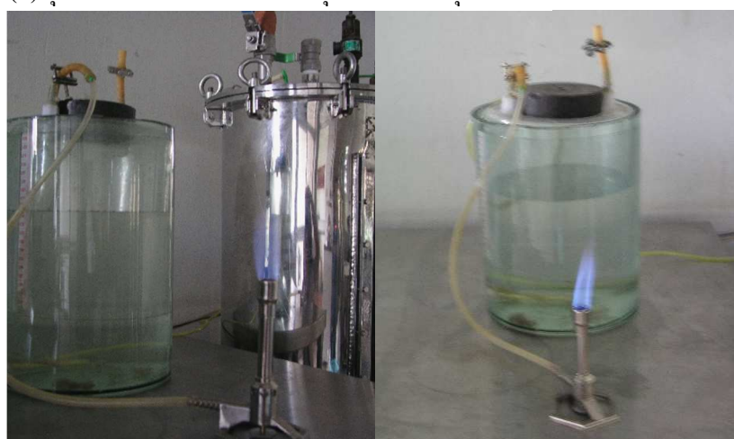
รูปที่ 3.29 ชุดวัดปริมาตรก๊าซชีวภาพ และชุดทดสอบการจุดติดไฟของก๊าซที่ได้จากการผลิตมีเทน ในรูปก๊าซชีวภาพจากหัวมันและกากมันสำปะหลังใน Single-stage digester ที่มีปริมาตร หมัก 50 ลิตร
