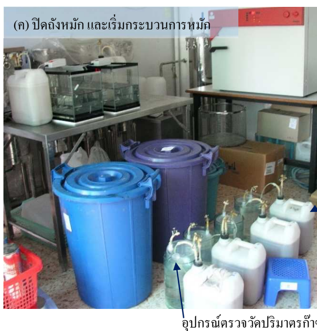
รูปที่ 3.6 การใช้เชื้อเริ่มต้น (Seed culture) เพื่อผลิตก๊าซชีวภาพจากวัตถุดิบหัวมันสำปะหลังในถังบรรจุวัสดุหมักปริมาตร 10 ลิตร
