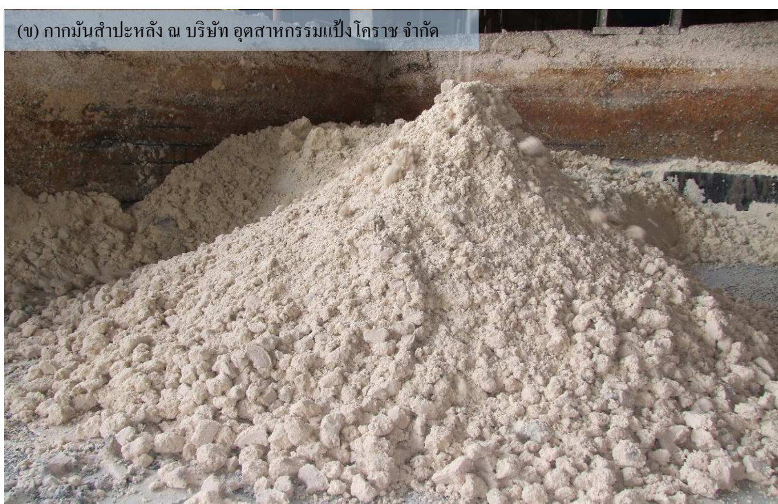
รูปที่ 3.2 ลักษณะของหัวมันสำปะหลัง (ก) ที่ใช้ผลิตแป้งมันสำปะหลัง ได้ของเหลือเป็นกากมัน สำปะหลัง (ข) ที่นำมาใช้เป็นวัตถุดิบทดลองผลิตมีเทน
