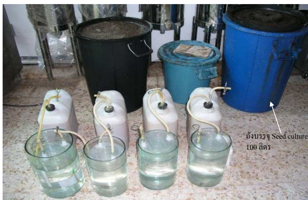
รูปที่ 3.7 ลักษณะของถังบรรจุวัสดุหมักก๊าซชีวภาพปริมาณ 5 ลิตร อุปกรณ์วัดปริมาตรก๊าซโดยการแทนที่น้ำ และถังบรรจุเชื้อเริ่มต้น (Seed culture)
