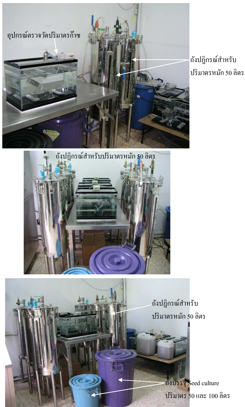
รูปที่ 3.10 ถังปฏิกรณ์ชีวภาพสำหรับปริมาตรหมัก 50 ลิตร ที่ต่อเชื่อมกับอุปกรณ์ตรวจวัดปริมาตร ก๊าซ และถังบรรจุ Seed culture
