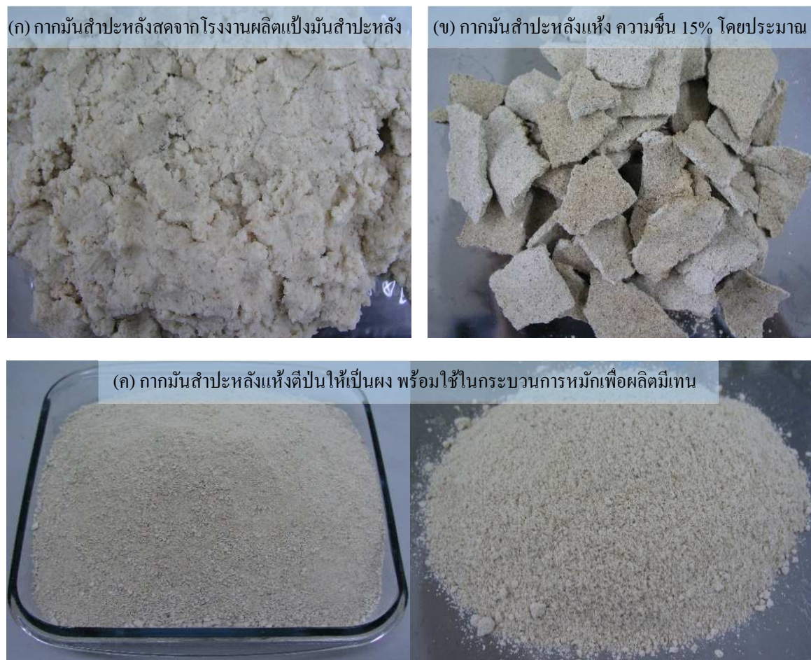
รูปที่ 3.4 ลักษณะของกากมันสำปะหลังสด (ก) และกากมันสำปะหลังแห้ง (ข และ ค) ที่เตรียมเพื่อให้มีความคงที่ของปริมาณส่วนประกอบของสารอาหารสำหรับการหมักเพื่อให้ได้ก๊าซมีเทน
