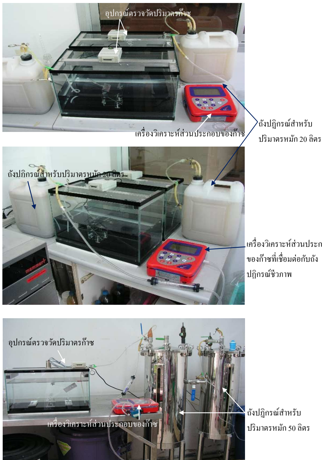
รูปที่ 3.11 ถังปฏิกรณ์ชีวภาพสำหรับปริมาตรหมัก 20 และ 50 ลิตร ที่เชื่อมต่อกับอุปกรณ์ตรวจวัดปริมาณก๊าซชีวภาพ และเครื่องวิเคราะห์ส่วนประกอบก๊าซชีวภาพที่เกิดขึ้นระหว่างกระบวนการหมัก (Gas Analyzer, Geotech Biogas Check Analyzer, Geotechnical Instruments Ltd., England)
