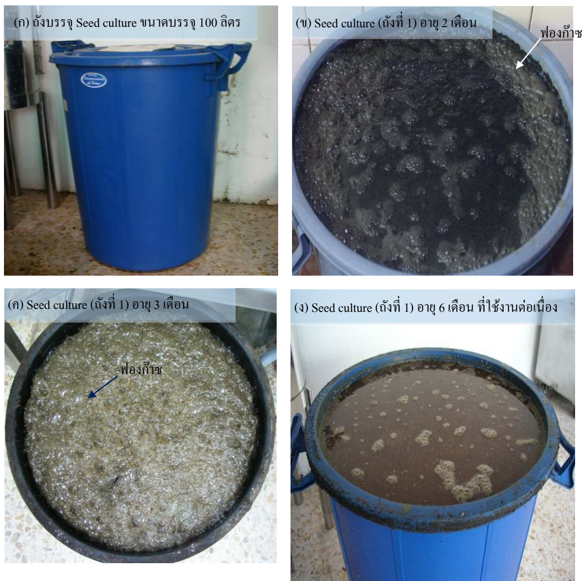
รูปที่ 3.5 ลักษณะของเชื้อเริ่มต้น (Seed culture) ที่กระตุ้นให้คุ้นเคยกับการย่อยสลายแป้งจากหัวมันสำปะหลังดิบในถังขนาดบรรจุ 100 ลิตร จำนวน 6 ถัง (ชุดการทดลอง) ที่เติมสารอาหาร (กากน้ำตาลและแป้งจากหัวมันสำปะหลัง) ในสัดส่วนและตามช่วงเวลาแตกต่างกัน เชื้อเริ่มต้นที่อ่อนแอ (active) ต่อการหมักให้เกิดก๊าซชีวภาพมีลักษณะฟองก๊าซที่ผิวหน้าของเหลว
