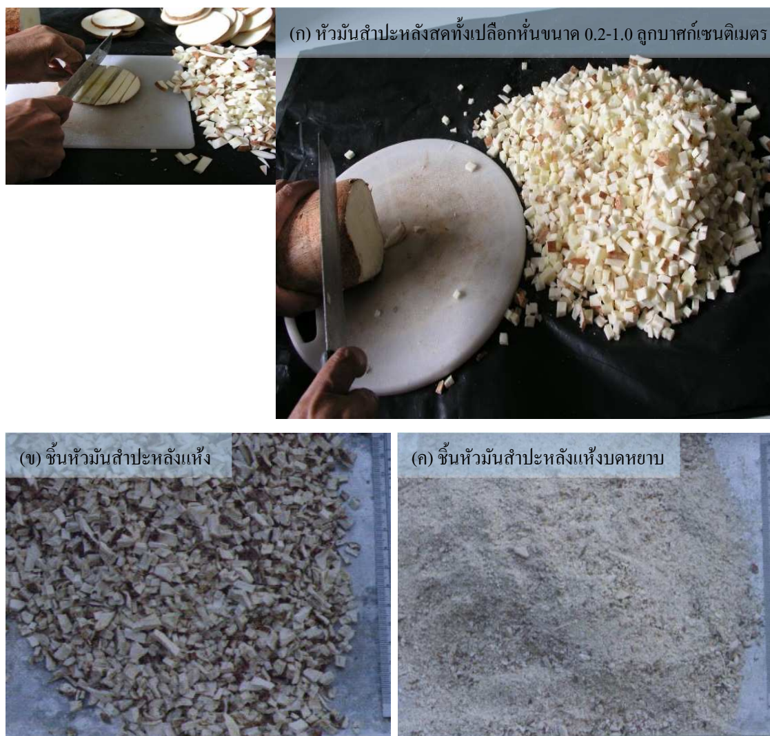
รูปที่ 3.3 ลักษณะของชิ้นหั้วมันสำปะหลังที่เตรียมเพื่อทดลองใช้เป็นวัตถุดิบในการผลิตมีเทน
