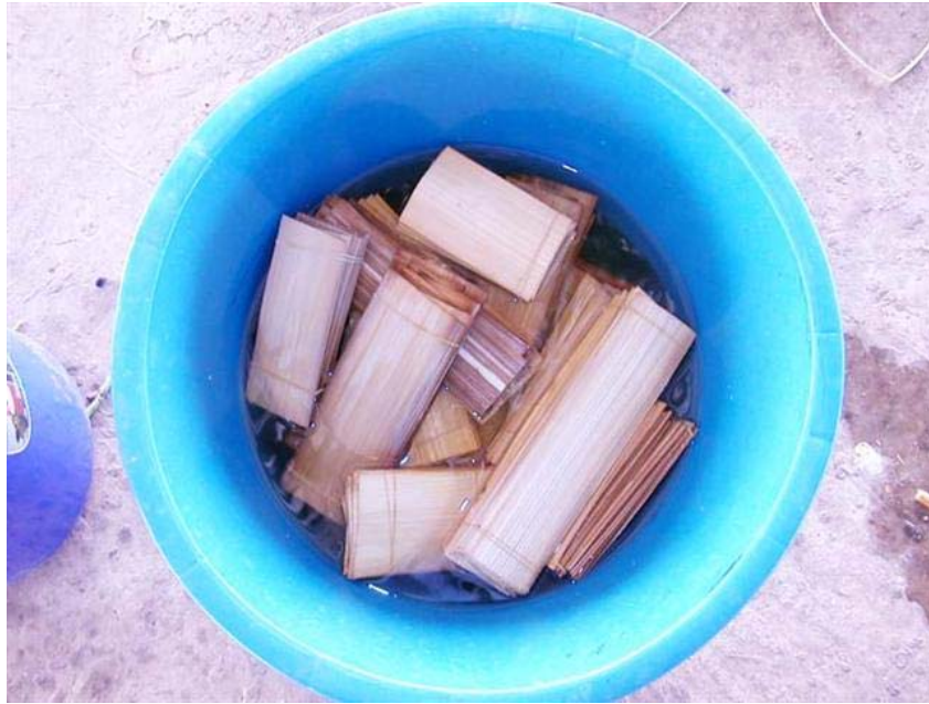
ภาพที่ 23 ไม้แปต้องแช่น้ำให้นิ่มก่อนนำมาใช้งาน
