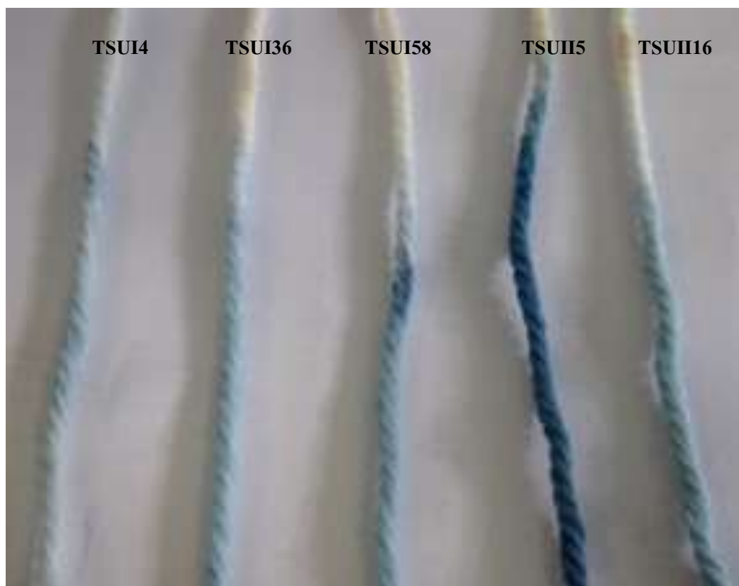
ภาพที่ 4.14 การย้อมสีเส้นด้ายดิบด้วยเชื้อที่คัดแยกได้ทั้ง 5 ไอโซเลต
