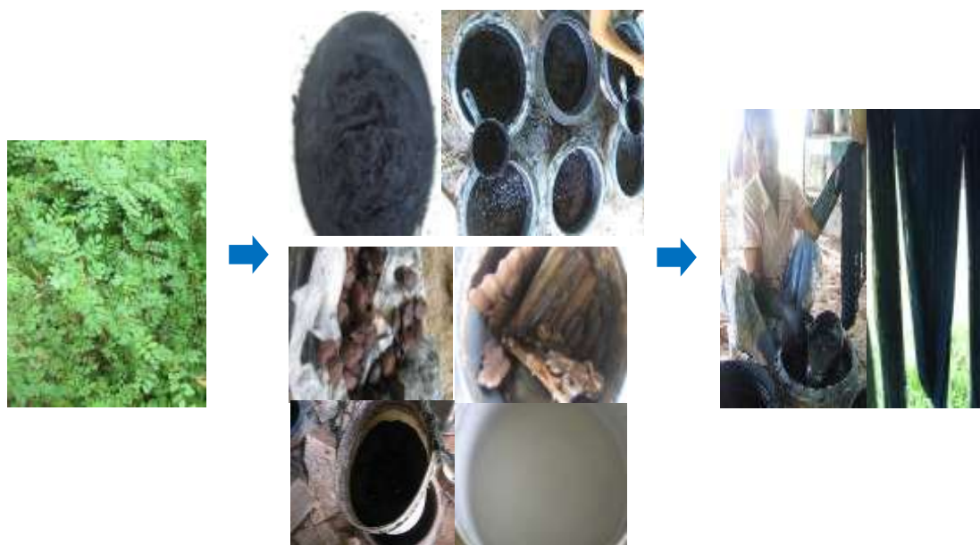
ภาพที่ 4.3 แสดงขั้นตอนกระบวนการย้อมสีครามที่ได้จากการสำรวจที่กลุ่มทอผ้าตำบลแพรกหา อำเภอกวนขนุน จังหวัดพัทลุง
