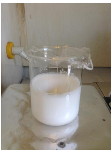
ภาพที่ 3.2 ภาพขณะทำการปั่นเหวี่ยงด้วยเครื่องหมุนวน (Magnetic stirrer)
