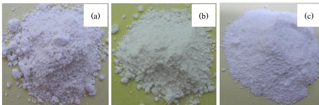
ภาพที่ 4.1 ผงนาโนซิงค์ออกไซด์ที่สังเคราะห์จาก a) \text{ZnCl}_2 , b) \text{Zn}(\text{NO}_3)_2 และ c) \text{Zn}(\text{CH}_3\text{COOH})
