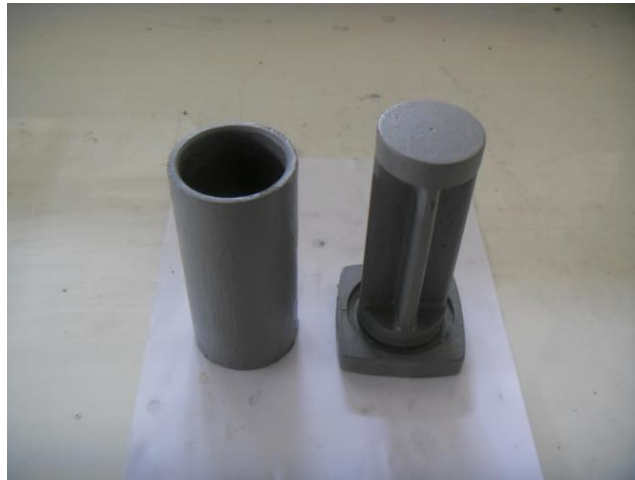
ภาพที่ 3.17 แบบสำหรับขึ้นรูปชิ้นงานในการทดสอบความต้านทานแรงอัด
