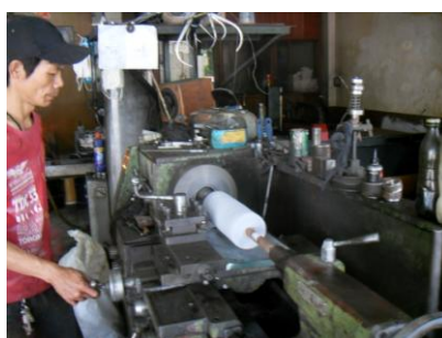
(ค) นำลูกหินไปกลึงเตรียมพร้อมใช้งาน
