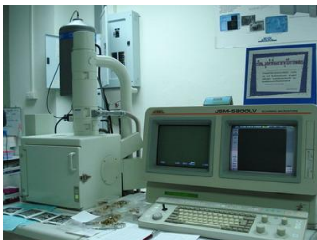
ภาพที่ 3.14 เครื่อง Scanning Electron Microscope (ภาควิชาชีววิทยา คณะวิทยาศาสตร์ มหาวิทยาลัยอุบลราชธานี)
