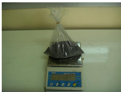
(ก) เตรียมวัสดุขี้ตีสีและชั่งน้ำหนักตามที่ได้ออกแบบ
