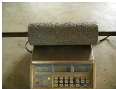
(ข) ชั่งน้ำหนักลูกหินขัดข้าวที่ได้ออกแบบไว้
