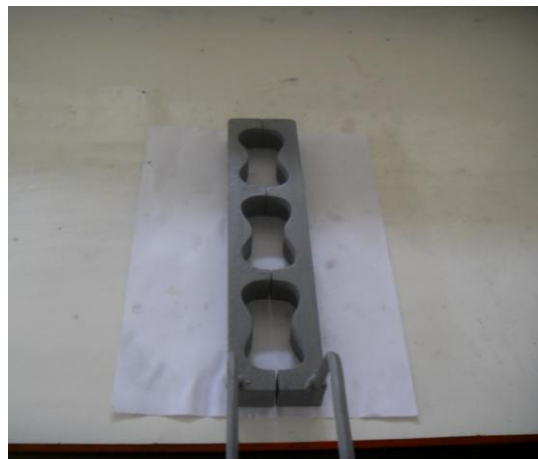
ภาพที่ 3.18 แบบสำหรับขึ้นรูปชิ้นงานในการทดสอบความต้านทานแรงดึง
