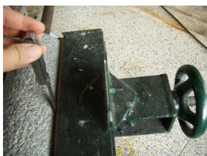
(ค) นำลูกหินมาประกอบและปรับระยะให้ได้ 1.5 mm
