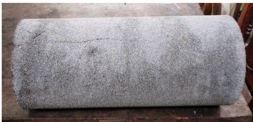
ภาพที่ 1.1 ลูกหินขัดที่เสียในกระบวนการผลิตซึ่งมีรอยร้าวเกิดขึ้น
