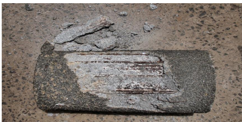
ภาพที่ 1.2 ลูกหินขัดที่เสียในกระบวนการผลิตซึ่งมีการเปราะแตกเกิดขึ้น
