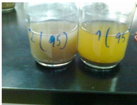
ภาพที่ 2 ลักษณะของเหลวที่ได้จากการหมักกากสับประดก่อนนำไปกลั่นด้วยไอน้ำเพื่อหาปริมาณแอลกอฮอล์
