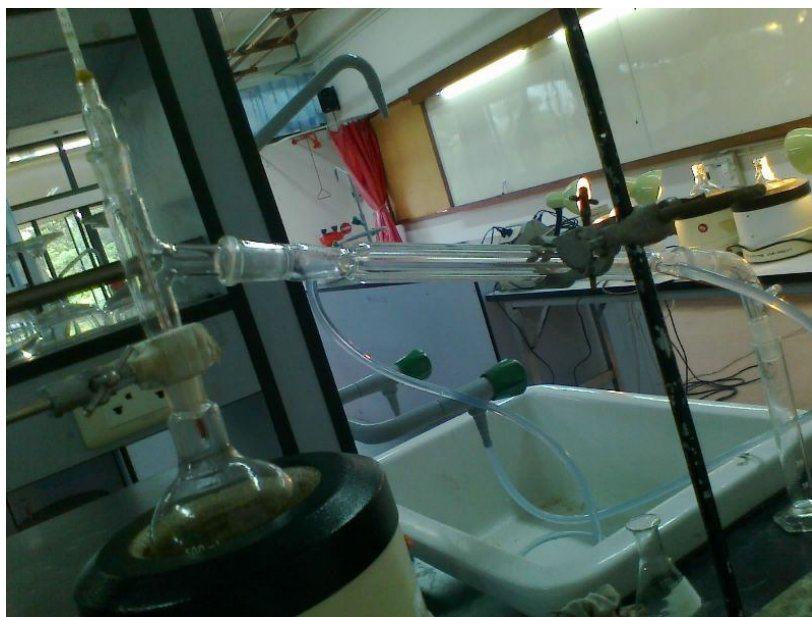
ภาพที่ 1 เครื่องกลั่นไอน้ำแบบธรรมดาที่ใช้ในการกลั่นแอลกอฮอล์ที่ได้จากการหมัก
