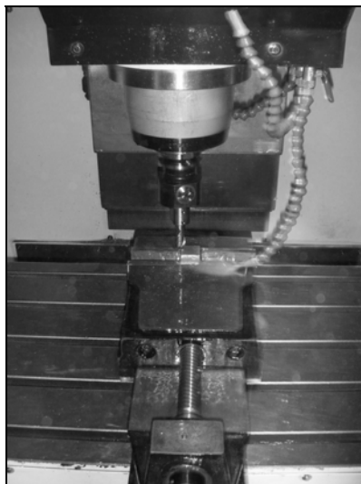
ภาพที่ 94 การกัดผิวชิ้นงานด้วยเครื่องกัดตั้งซีเอ็นซีสามแกน รุ่น Chevalier 2040 VMC
