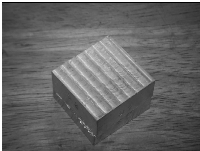
ภาพผนวกที่ ข18 ชิ้นงานที่ 2 ที่ผ่านกระบวนการกัด ด้วยค่า \theta = 2.0 องศา
