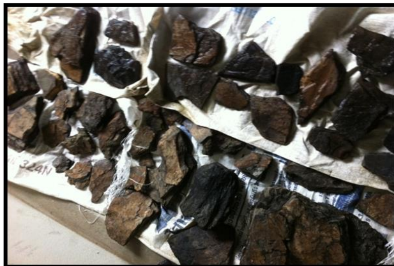
รูปที่ 3.4 ตัวอย่างหินน้ำมันที่นำมาล้างทำความสะอาด แล้วนำมาตากให้แห้ง
