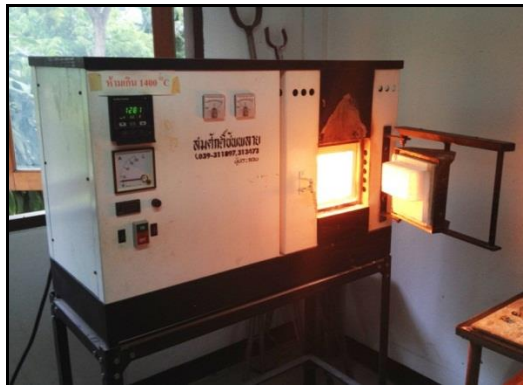
รูปที่ 3.11 แสดงเตาไฟฟ้าแบบ Muffle furnace
