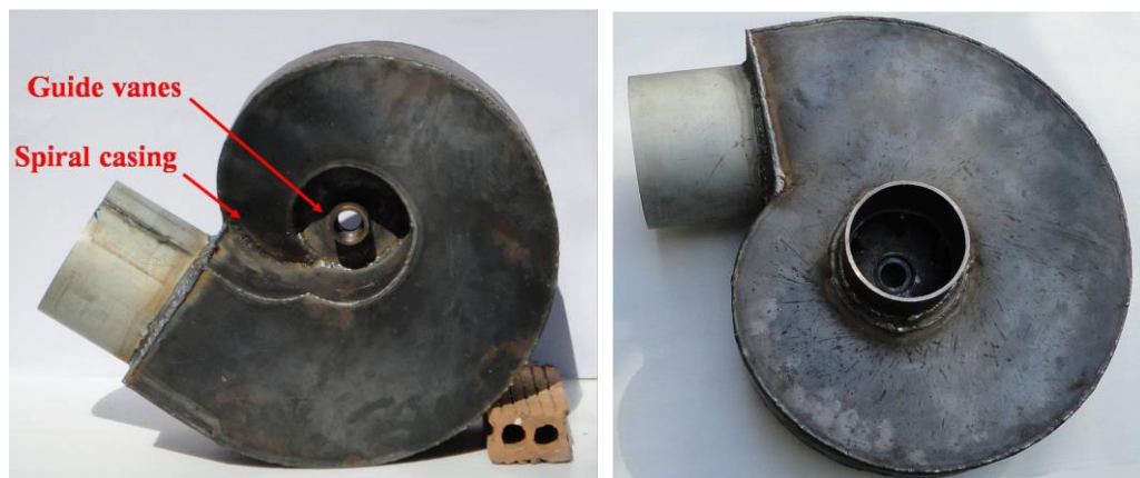
รูปที่ 3.18 การเชื่อมประกอบ Guide vanes กับ Spiral casing
