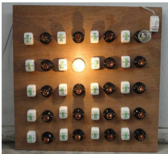
รูปที่ 3.26 แผงโหลดหลอดไฟ
