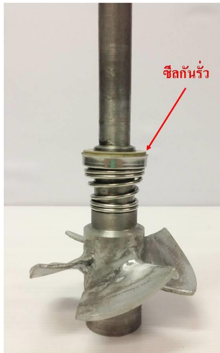
รูปที่ 3.20 การติดตั้งซีลกันรั่ว
