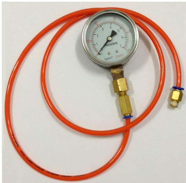
รูปที่ 3.24 เกจวัดความดันและอุปกรณ์ระบบ Pneumatic
