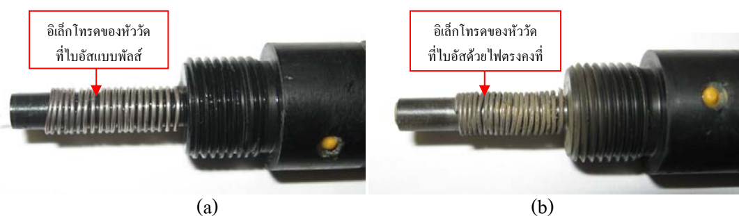
ภาพที่ 47 แสดงการเปรียบเทียบความสะอาดของอิเล็กโทรดที่ไบอัสแบบพัลส์ (a)และไบอัสด้วย ไฟตรงคงที่ (b) หลังจากมีการใช้งานอย่างต่อเนื่องนาน 45 วัน
