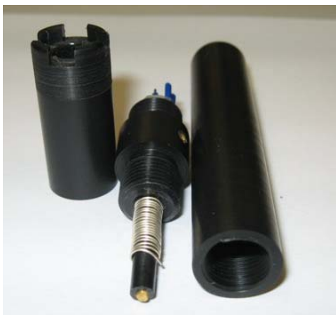
ภาพที่ 8 ประกอบอิเล็กทรอนิกส์และทองคำกับส่วนปลายหัววัดสำหรับยึดอิเล็กทรอนิกส์
